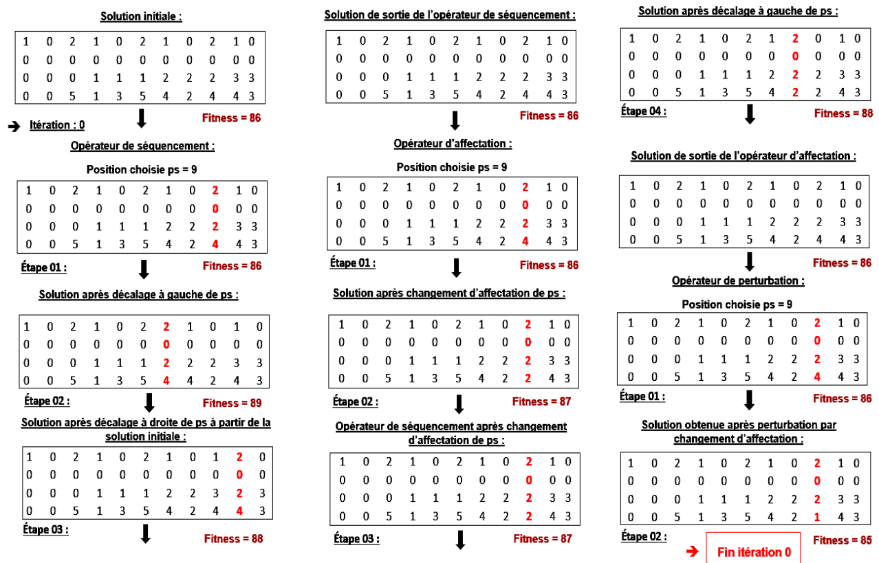
FIGURE 4.17 – Déroulement de l'algorithme ILS sur une itération.
