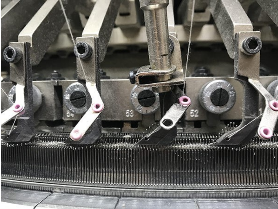
FIGURE 3.2 – Les machines rotatives tricotent grâce à leurs quelques 3 000 aiguilles
