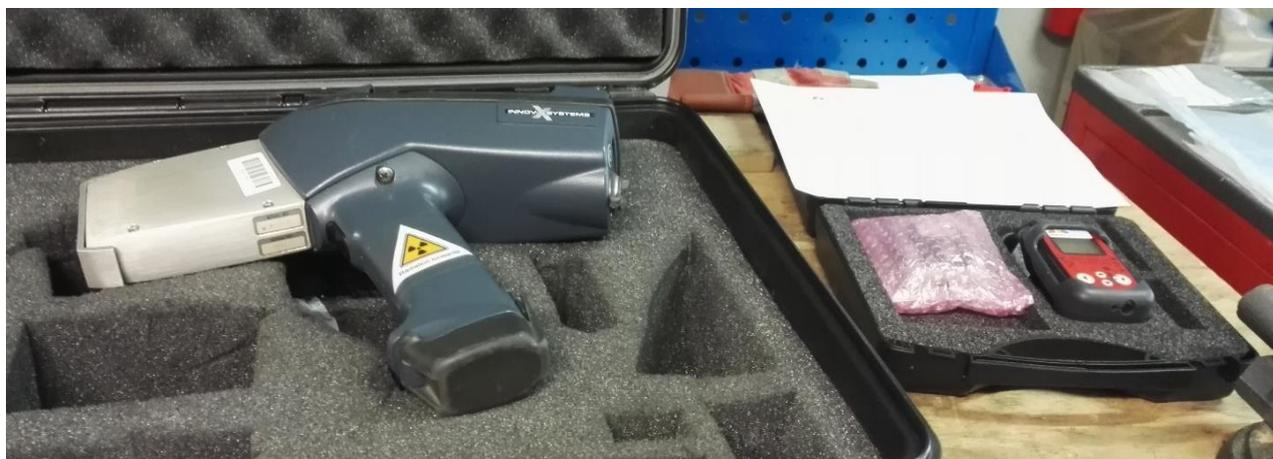
Figure 4-4 : Photographie du pistolet de fluorescence X (à gauche) et du dosimètre (à droite) [20]
