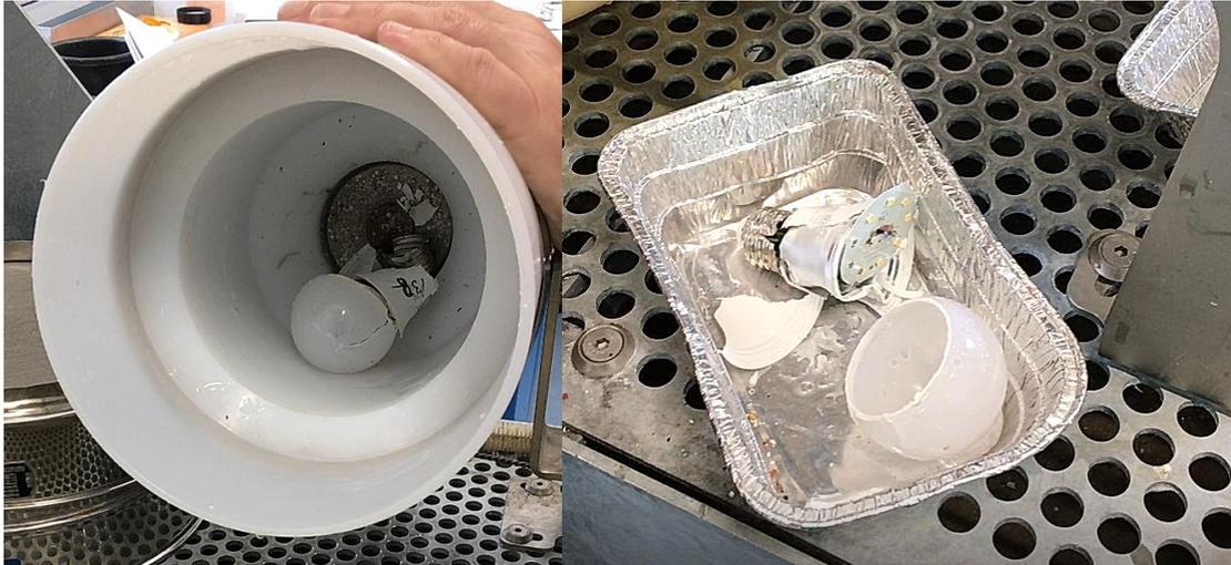
**Figure 3-34** : Exemples de photographies de la récupération des constituants élémentaires des lampes E27 en plastique, après le traitement au SELFRAG Lab
