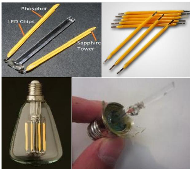
Figure 1-8 : Puces à LED à filaments [3]
