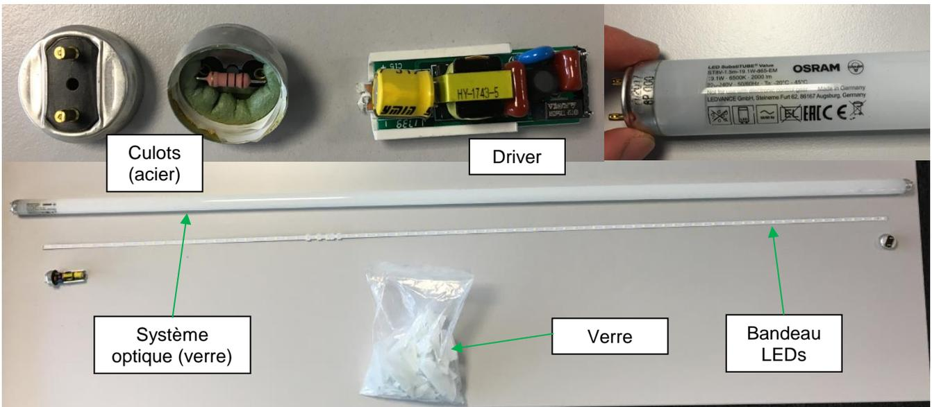
**Figure 5 :** Désassemblage manuel d'un tube à LED verre OSRAM, 19,1 W, 150 cm, 6500 K, masse 236 g et 84 puces LEDs (fabrication 2014)
