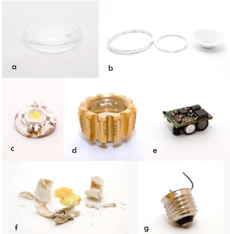
**Figure 4-27** : Démontage d'une lampe à LED : Système optique (a), joint silicone (b), plateau à LED (c), dissipateur thermique (d), driver (e), corps (f) et le culot (g) [61]
