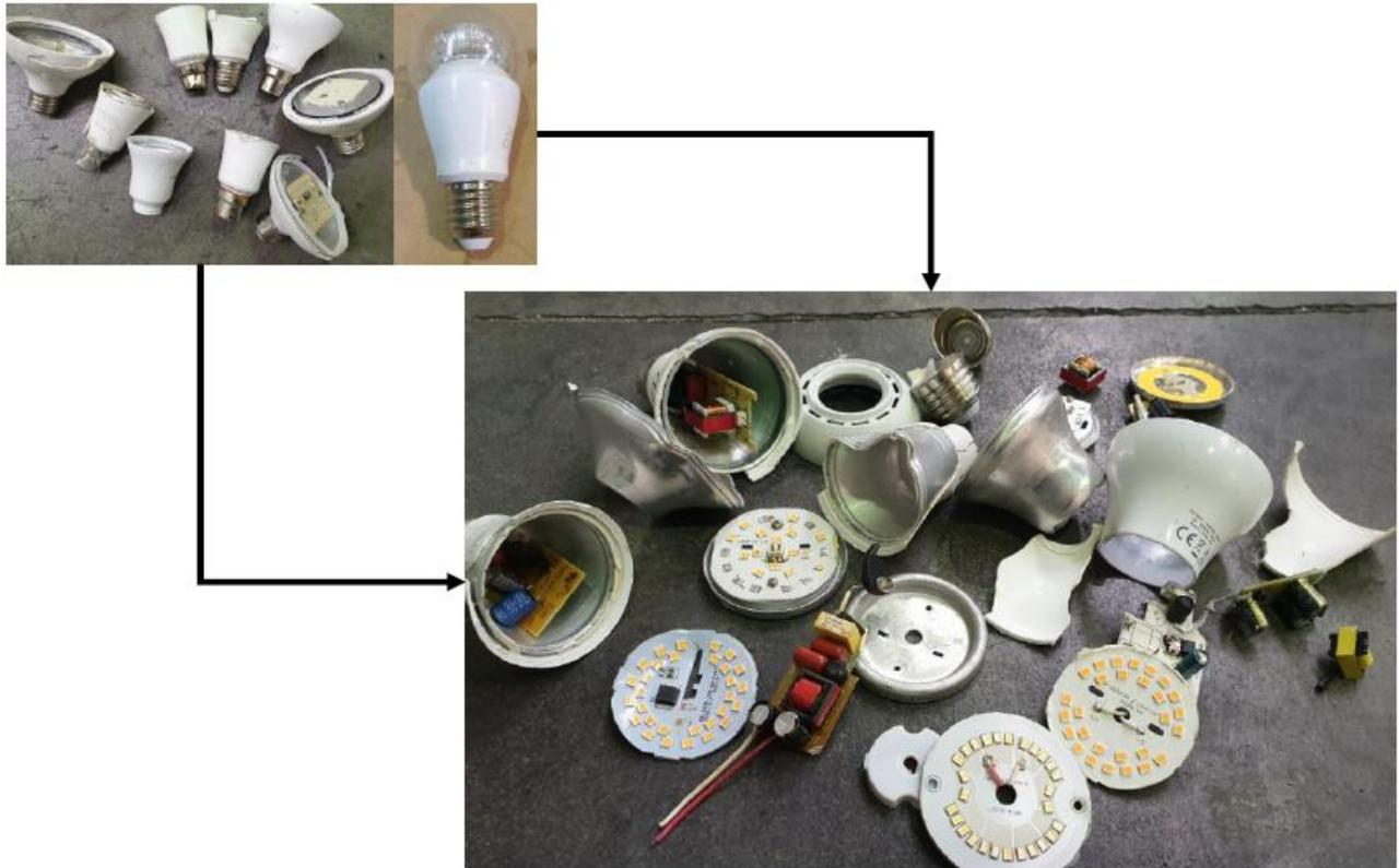
**Figure 3-21** : Tests de séparation des lampes à LED avec des corps en plastique
