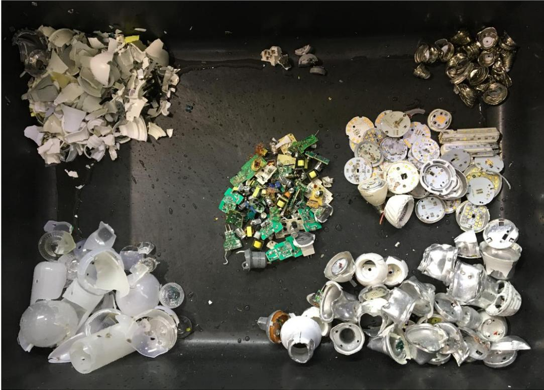
**Figure 3-67** : Résultats de la fragmentation sélective en flux continu des équipements à LED dépourvus des systèmes en verre et en corps entièrement métalliques
