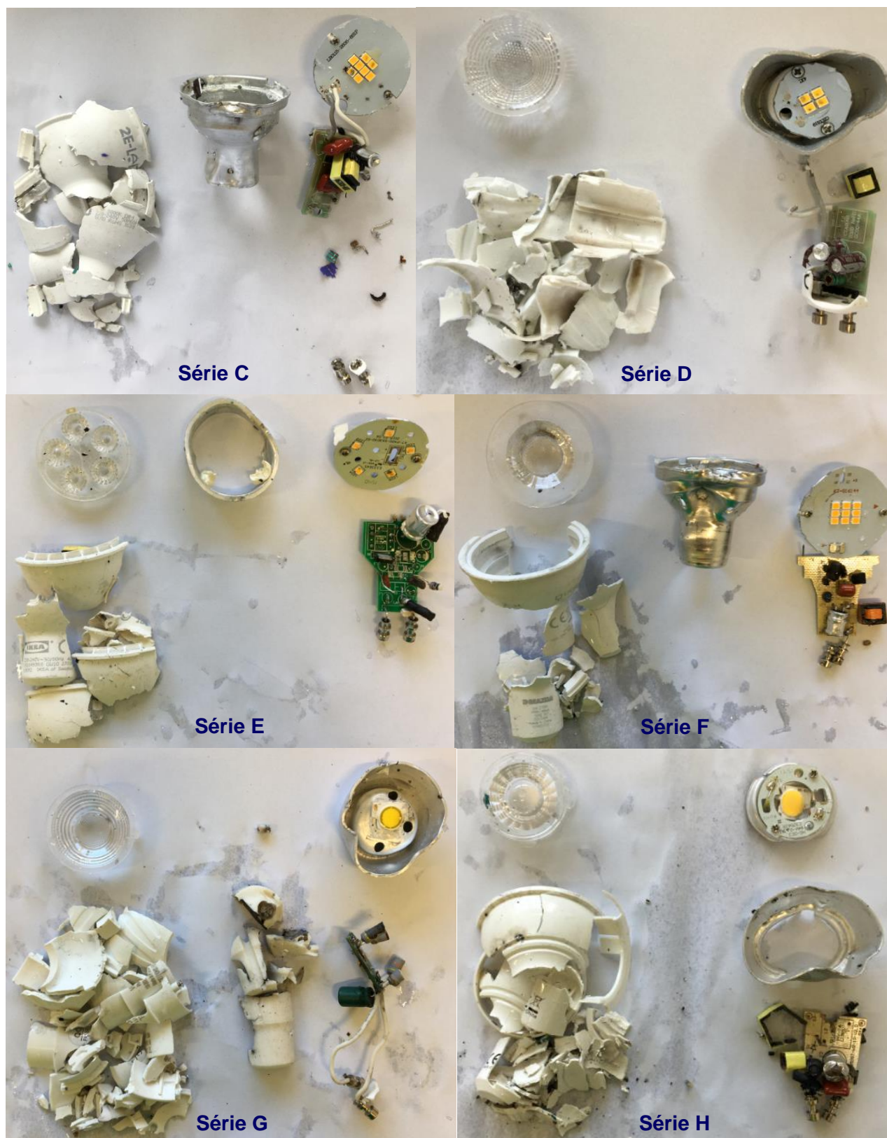
Figure 3-53 : Exemples de photographies des 8 séries d'essais A à H, des fragmentations sélectives favorables pour les spots GU10 en plastique
