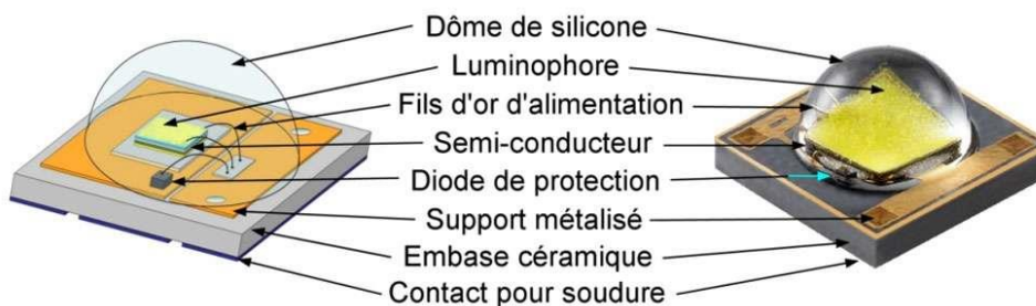
Figure 3-30 : Puce à LED et ses éléments constitutifs [52]
