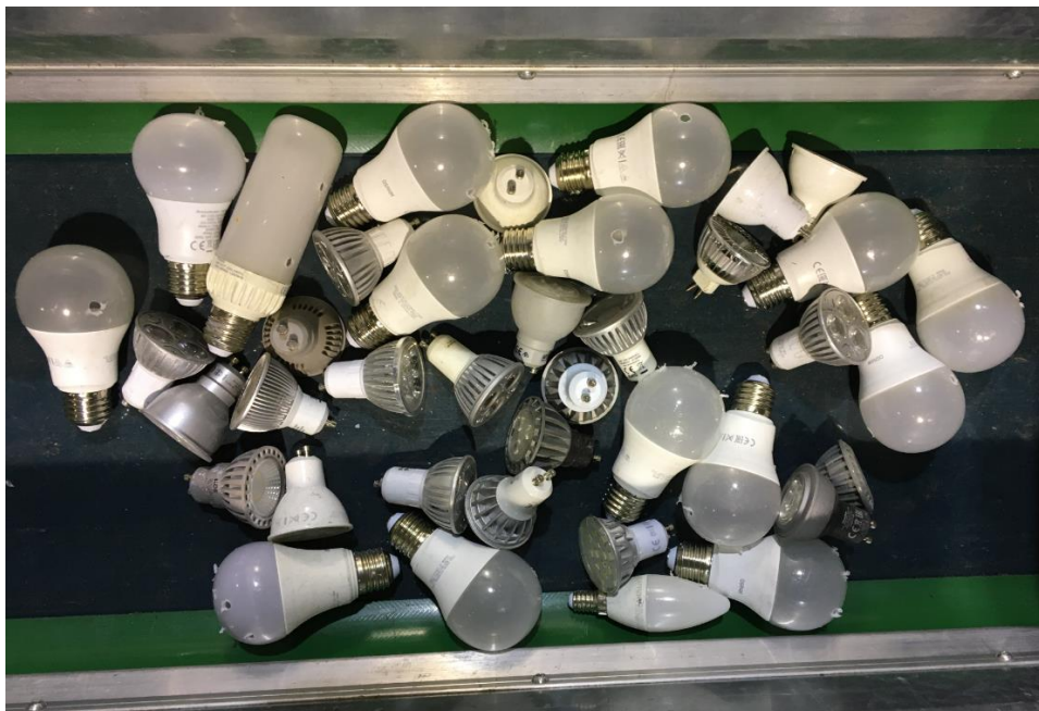
Figure 3-63 : Equipements à LED dépourvus des parties ou systèmes en verre
