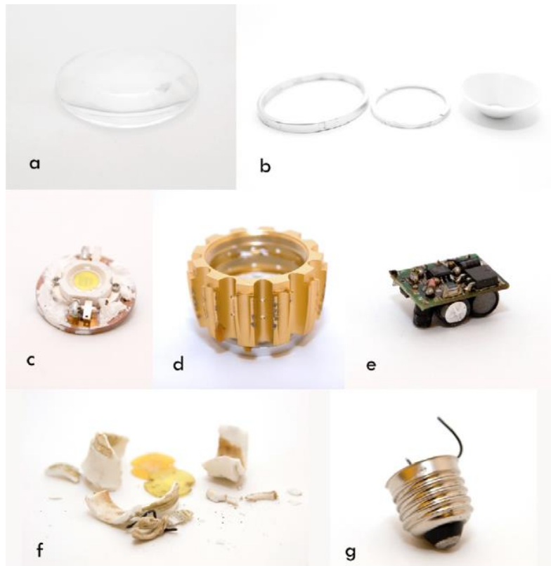
Figure 4-27 : Démontage d'une lampe à LED : Système optique (a), joint silicone (b), plateau à LED (c), dissipateur thermique (d), driver (e), corps (f) et le culot (g) [61]
