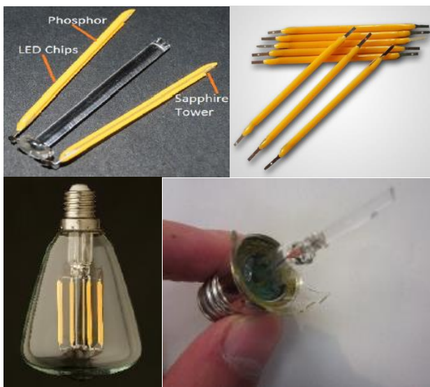
Figure 1-8 : Puces à LED à filaments [3]
