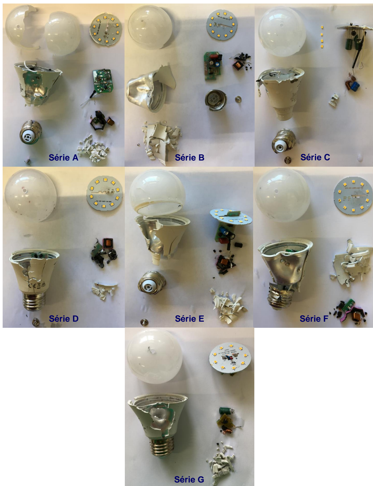
Figure 3-38 : Exemples de photographies des 7 séries d'essais A à G, des fragmentations sélectives favorables pour les lampes E27 en plastique
