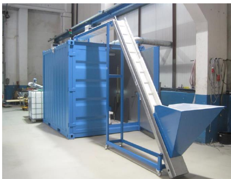
Figure 3-16 : Installation industrielle de recyclage IMPULSTEC en flux continu
