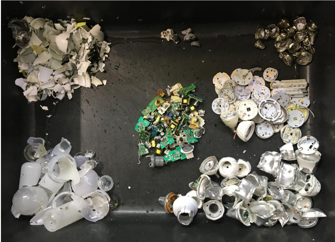
Figure 3-67 : Résultats de la fragmentation sélective en flux continu des équipements à LED dépourvus des systèmes en verre et en corps entièrement métalliques
