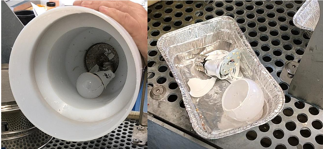
Figure 3-34 : Exemples de photographies de la récupération des constituants élémentaires des lampes E27 en plastique, après le traitement au SELFRAG Lab
