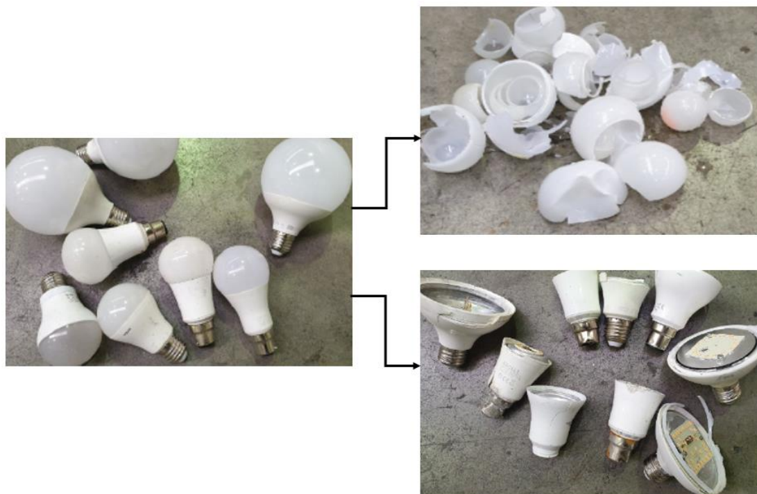
Figure 3-20 : Tests de séparation des lampes à LED avec des bulbes en plastique
