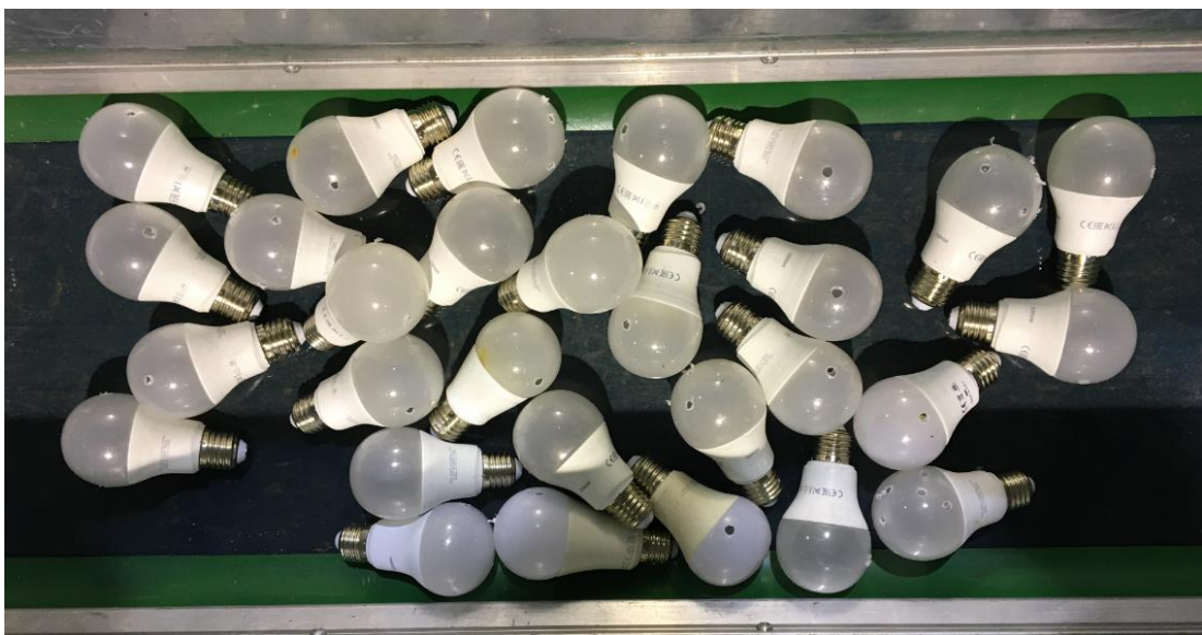
Figure 3-68 : Equipements à LED E27 en plastique, avec un traitement préalable de perçage
