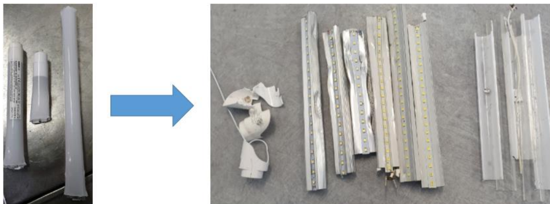
Figure 3-25 : Tests de séparation des tubes à LED en aluminium
