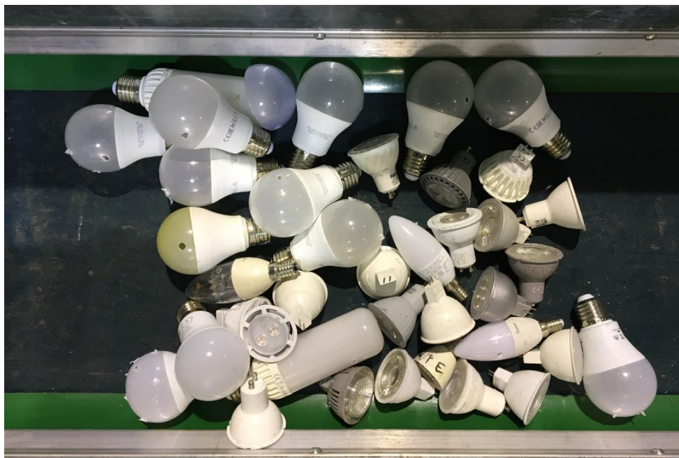
Figure 3-66 : Equipements à LED dépourvus des systèmes en verre et en corps entièrement métalliques
