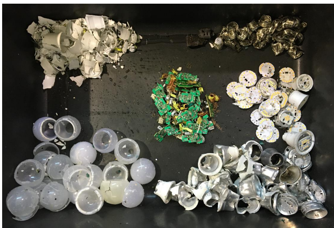
Figure 3-69 : Résultats de la fragmentation sélective en flux continu des équipements à LED E27 en plastique
