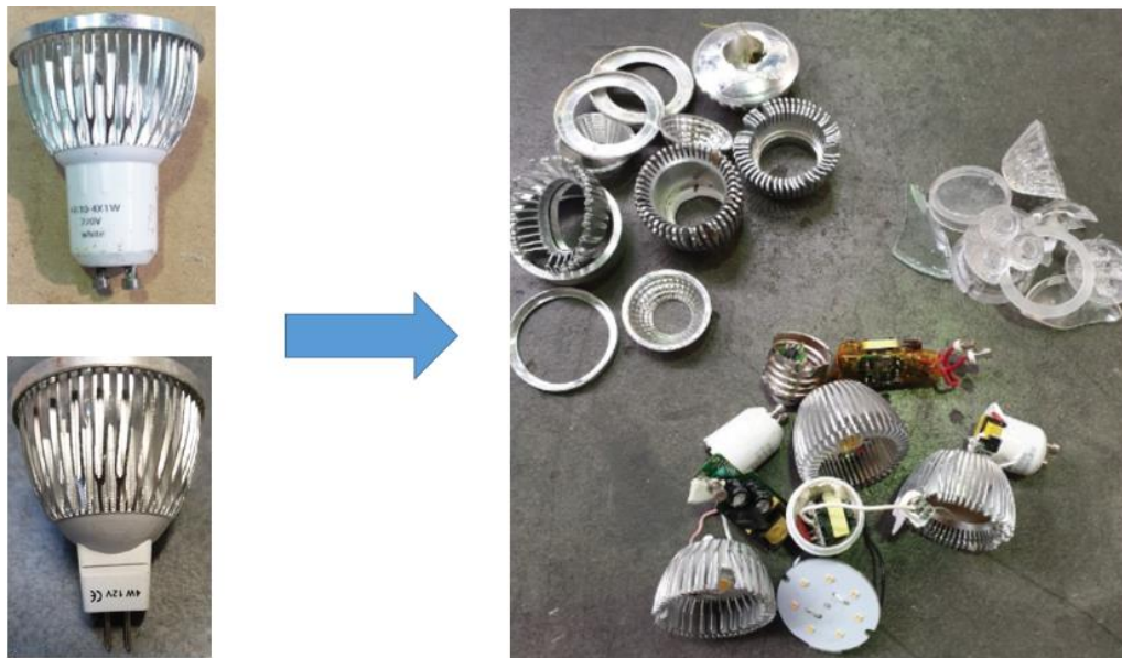
Figure 3-23 : Tests de séparation des spots à LED GU10 et GU5.3 avec des corps en aluminium
