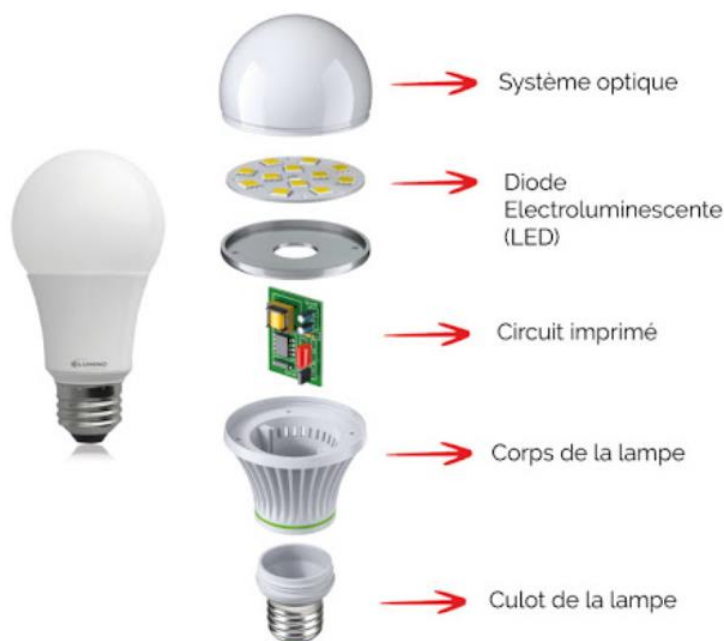
Figure 1-1 : Composition d'une lampe E27 à technologie LED [3]
