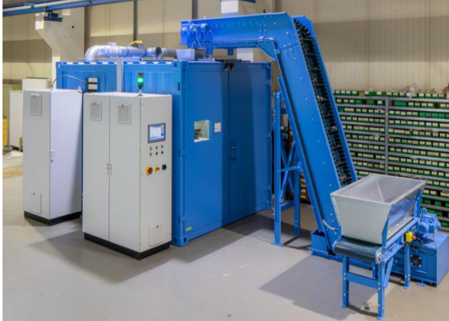
Figure 3-62 : Réacteur IMPULSTEC de fragmentation EHF en flux continu utilisé
