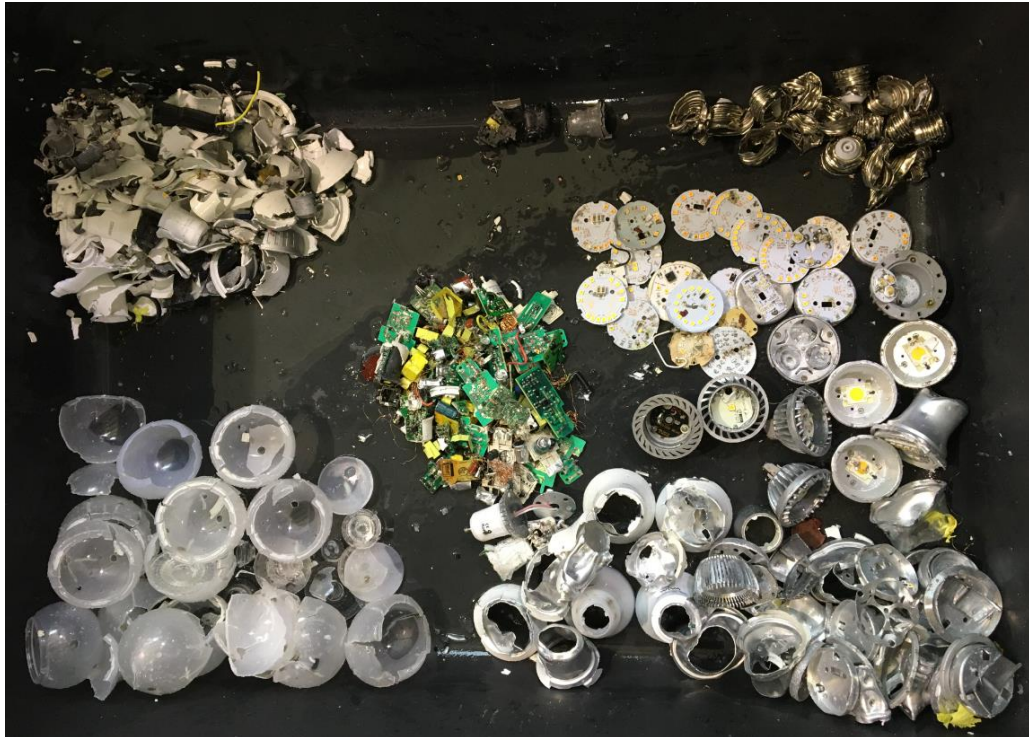
Figure 3-64 : Résultats de la fragmentation sélective en flux continu des équipements à LED dépourvus des systèmes en verre
