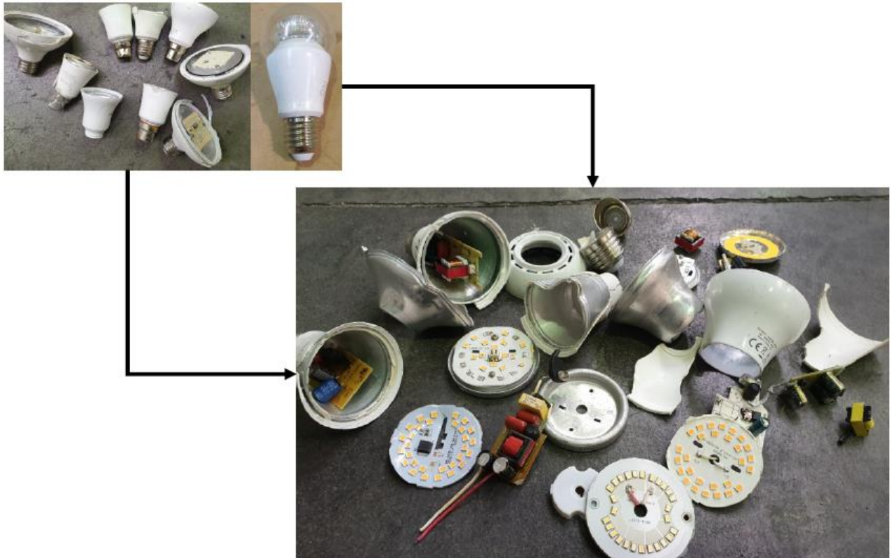
Figure 3-21 : Tests de séparation des lampes à LED avec des corps en plastique
