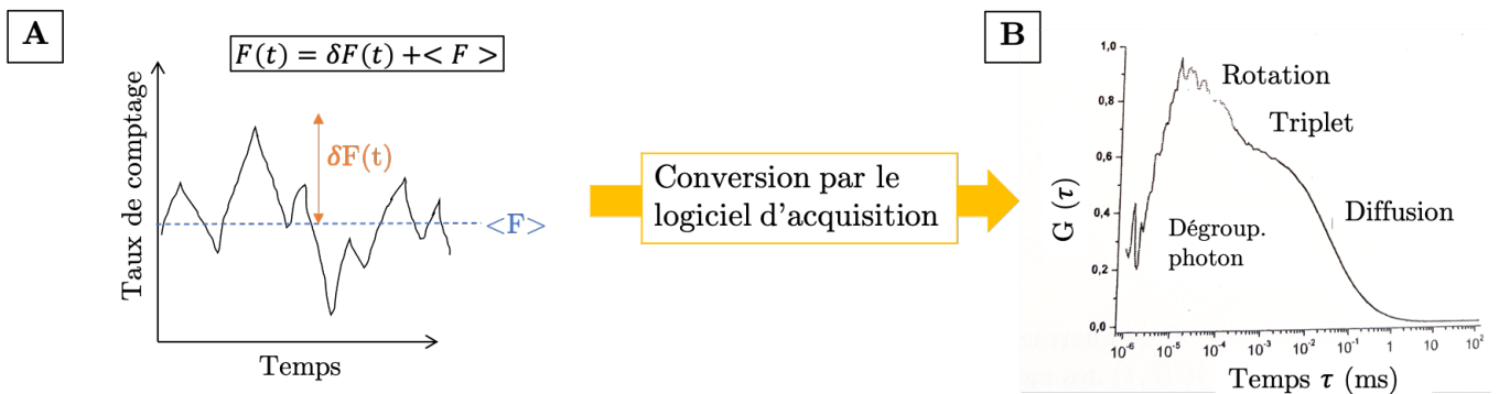
FIGURE 1.18 – Illustration de l'étude de la fluctuation de la fluorescence en FCS. En A, un schéma type du signal moyen de fluorescence mesuré par le détecteur et en B, la courbe de corrélation associée.
