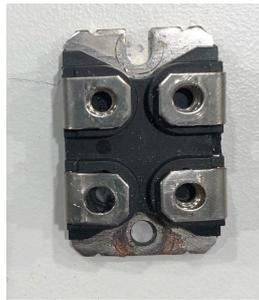
FIGURE 6.18 – MOSFET sélectionné : IXFN132N50P3
