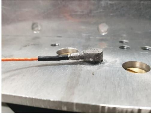
Figure 2.14 : Accéléromètre piézoélectrique monté sur le support.
