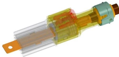
Figure 2.5 : Présentation 3D des boîtiers mâle et femelle, portant les éléments de contact.
