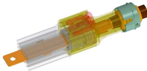
Figure 2.5 : Présentation 3D des boîtiers mâle et femelle, portant les éléments de contact.
