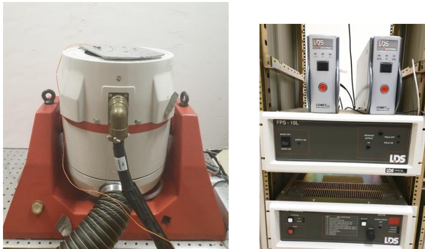
Figure 2.9: Dispositif du pot vibrant LDS V555 et PA 500L Amplifier.
