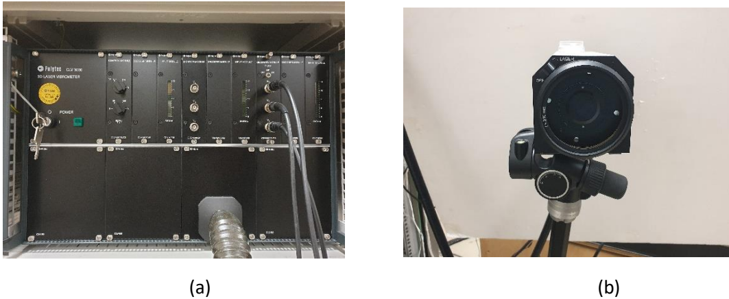
Figure 2.15: Vibromètre 3D-laser, (a) contrôleur CLV-3000 Polytec, (b) capteur laser CLV-3D Polytec.
