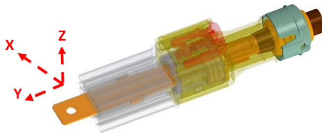
Figure 3.1: Définition des axes pour les mesures des mouvements
