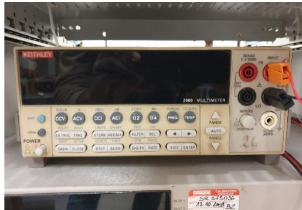
Figure 2.25: Microvoltmètre Keithley série 2000 utilisé pour mesurer la résistance de contact.
