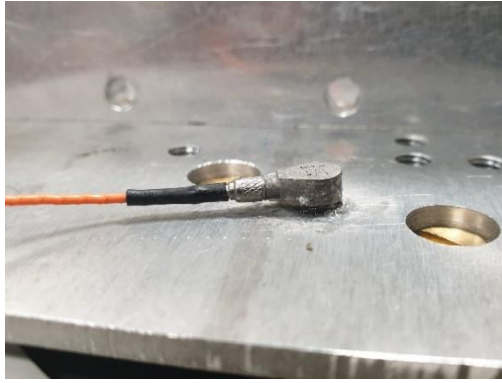
Figure 2.14 : Accéléromètre piézoélectrique monté sur le support.
