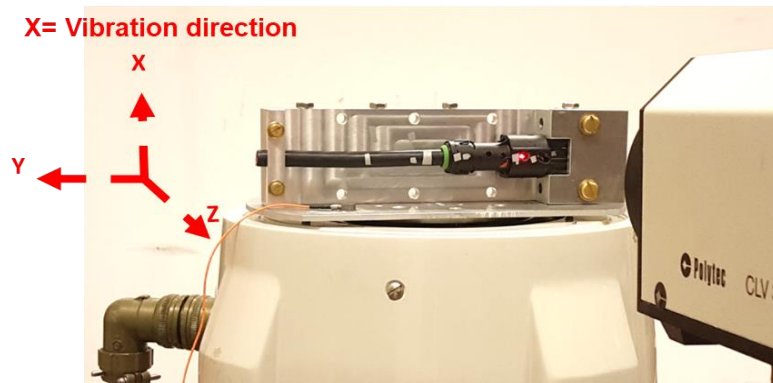
Figure 2.12: Représentation du montage pour une excitation dans la direction Latérale ( \parallel à l'axe X).
