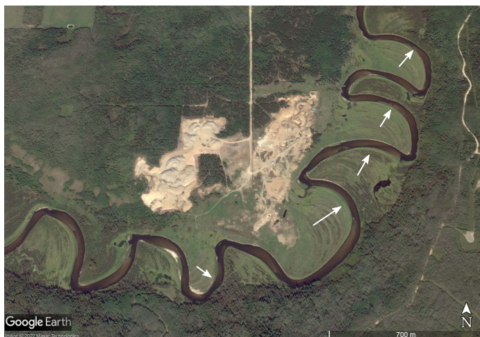
Figure 5.6: Barres de méandres nettement visibles sur la Beaver River, du fait de la couverture végétale très rase (les flèches indiquent la direction de construction de la barre). Ces zones étant les premières à être submergées au-delà du régime de plein-bord, la représentation fine de leur hypsométrie (au niveau statistique) est importante.
