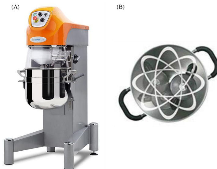
Figure 4.32 : (A) Equipement Starmix® modèle PL40N3V0 et (B) représentation schématique d'un mouvement planétaire.
