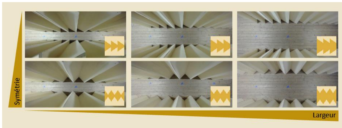
Figure 54. Construction de six couloirs aux géométries ratchets à échelle humaine
