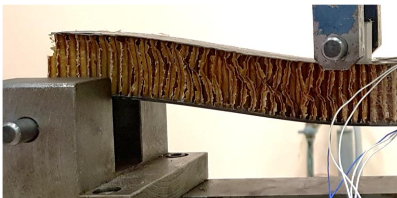
Figure 2-19. Rupture du nid d'abeille en cisaillement
