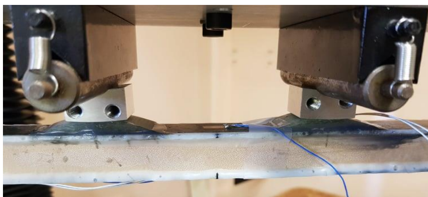
Figure 2-24. Photographie de l'éprouvette avec talon en verre époxy d'épaisseur 5mm
