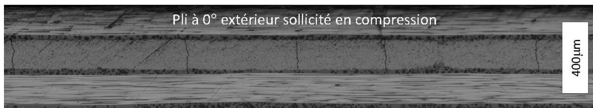
Figure 3-13. Observation microscopique du pli à 90^\circ adjacent au pli à 0^\circ situé à l'extérieur sur la stratification [(0/90)_4/0_2]_s pour un niveau de déformation de 1%
