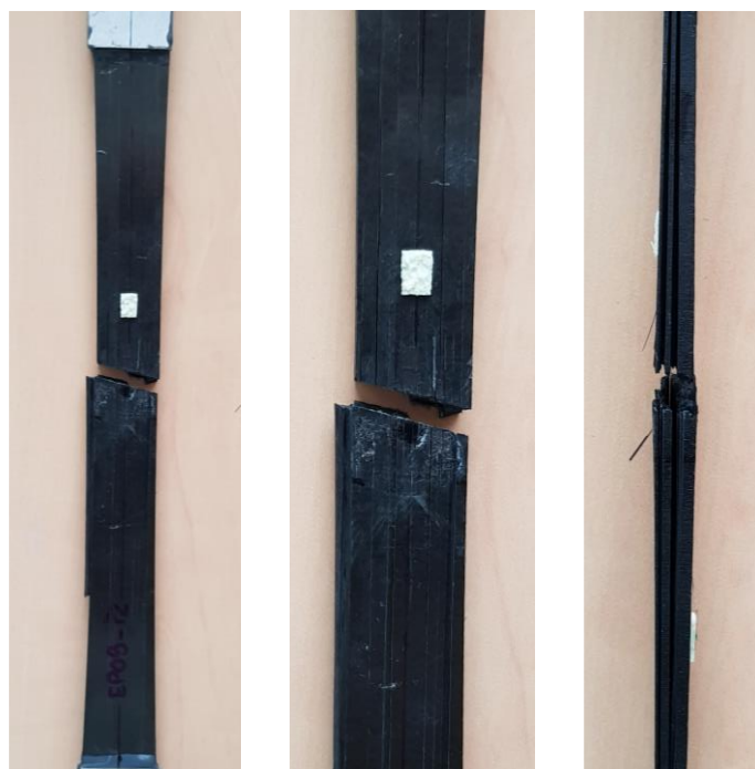
Figure 3-8. Illustration de l'état après rupture sur une éprouvette d'épaisseur 4mm (Ep. 3)
