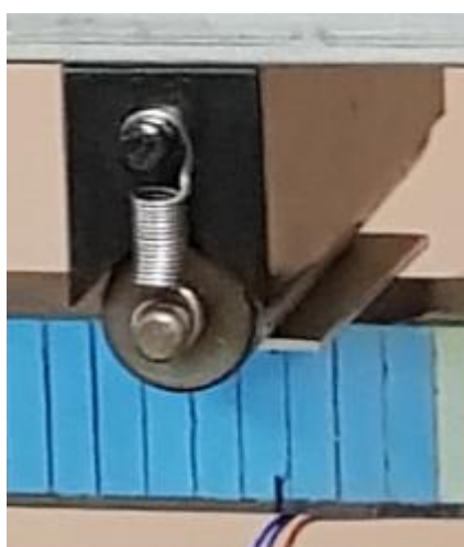
Figure 2-20. Patin en aluminium sous la tige d'appui utilisé pour la configuration 3
