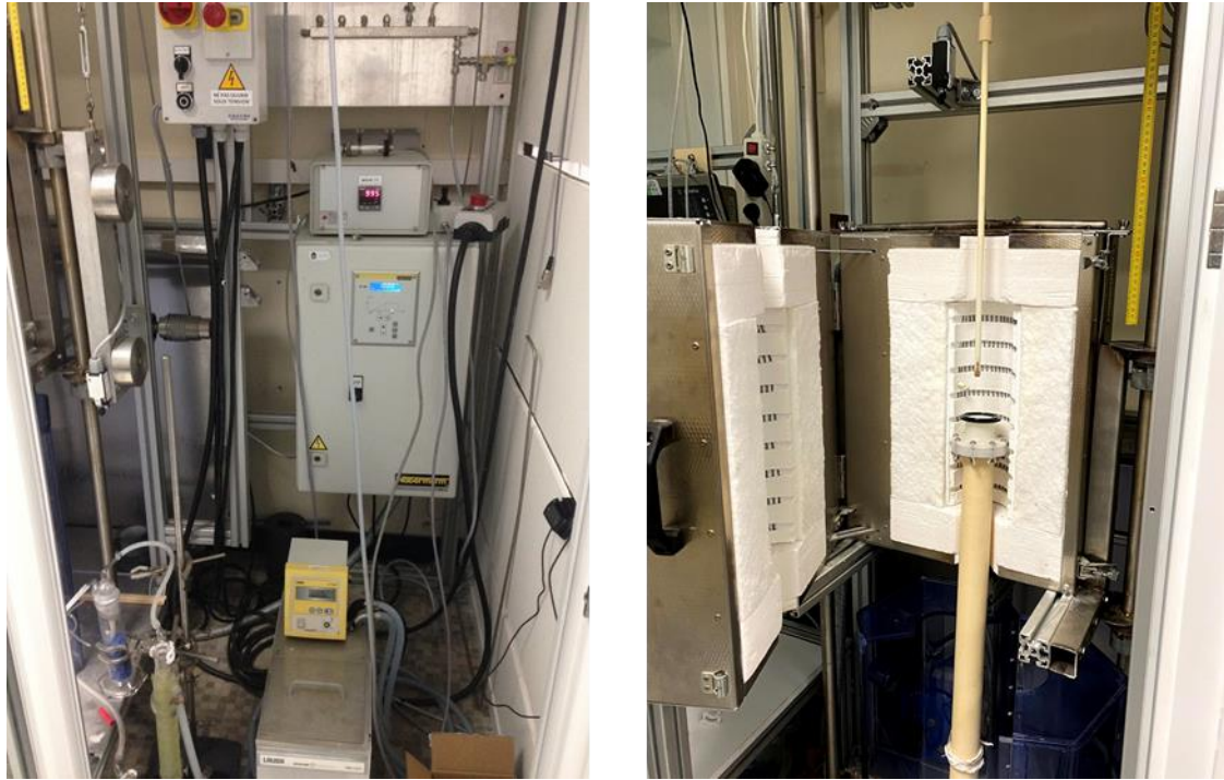
Figure 34 : Installation de couplage ATG-CPG
