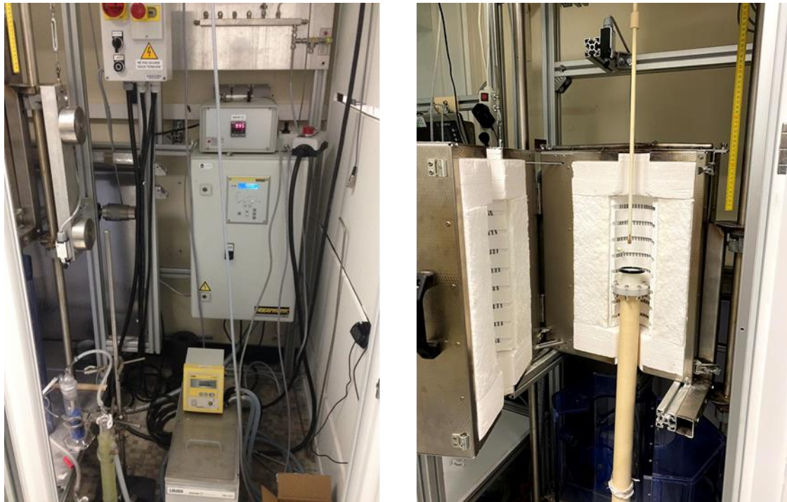
Figure 34 : Installation de couplage ATG-CPG
