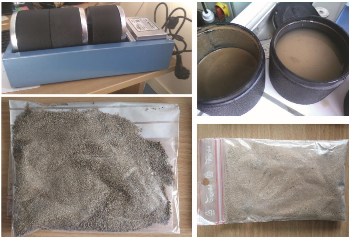
Figure 27: Tambours et sables utilisés. À gauche: sable du Membre F, à droite : sable quartzeux des Landes.
