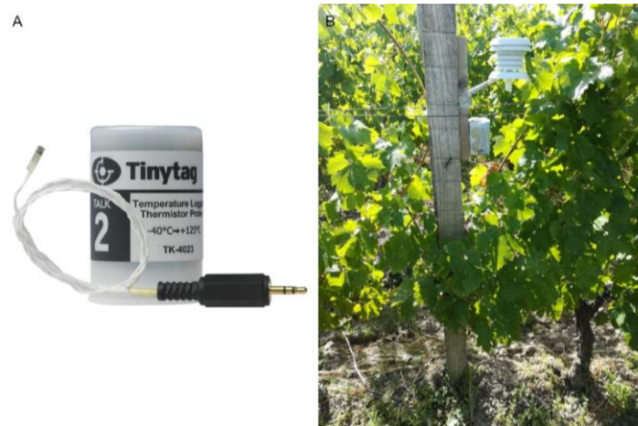
Figure 32. Capteur de température Tinytag B) dans un abri anti-radiation installé dans la végétation à 1m20 du sol
