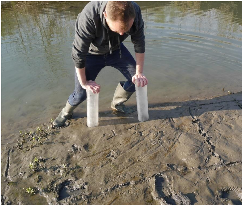
Figure II.15 : Photographie lors du prélèvement de sédiments à l'aide du carottier : étape 1 du protocole de mesure avec l'ERODIMETRE.
