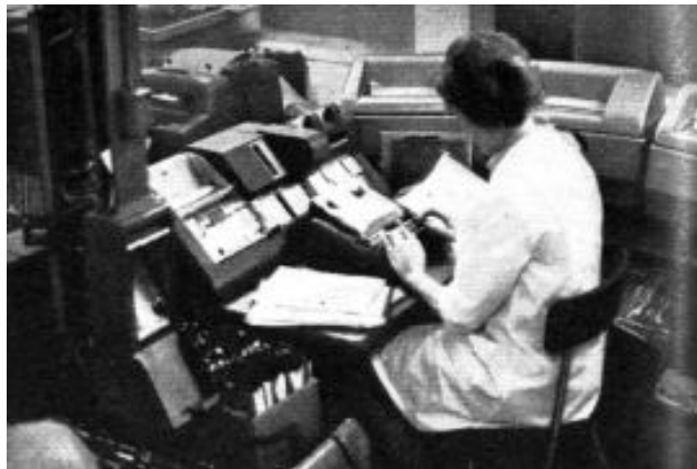
Figure 12. Claviers utilisés par les contrôleurs pour la mise à jour des données du plan de vol 11 .
