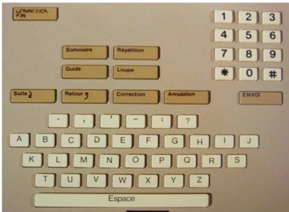
Figure 20. Clavier retenu pour l'Annuaire Electronique et première disposition des touches 20 .
