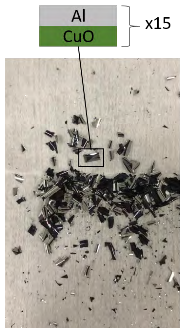
FIGURE 2.6 – Exemple de feuillets Al/CuO récupérés après lift-off, composés de 15 bicouches.
