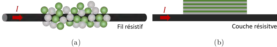
FIGURE 1.13 – Représentation schématique du procédé d'initiation par chauffage résistif, de nanothermites sous forme (a) nanopoudres et (b) nanolaminés.
