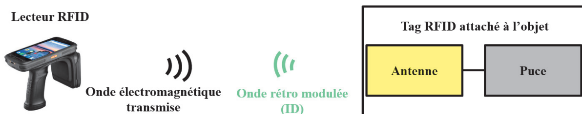
Figure 3. Illustration du principe d'une communication RFID
