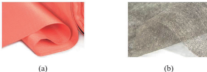
Figure 7. Exemples de tissus conducteurs commerciaux : (a) tissu conducteur tissé ; (b) tissu conducteur non tissé [17]
