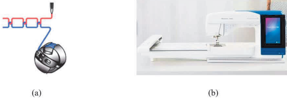
Figure 8. Illustration de la technique de broderie : (a) technique de broderie : fil principal conducteur et fil boucleur isolant (principe du tissu chaîne et trame) [18] ; (b) machine à broder Husqvarna Viking [19]
