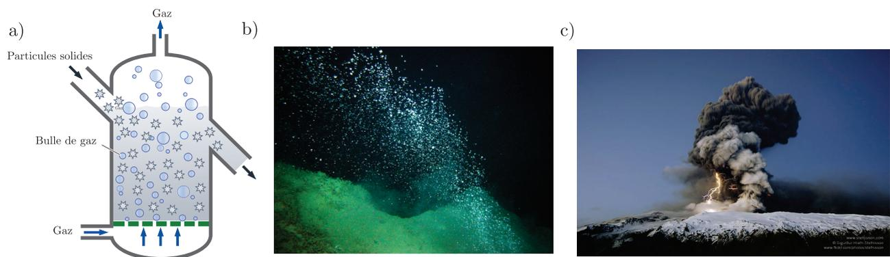
FIGURE 3 - **Exemples.** a) Schéma simplifié d'un réacteur à lit fluidisé (Wikimedia Commons). b) Essaim de bulles de méthane s'échappant du fond de la mer (Alfred Wegener Institut). c) Éruption volcanique au-dessus de l'Eyjafjallajökull en Islande pendant une éruption en 2010 (Sigurdur Stefni-son).
