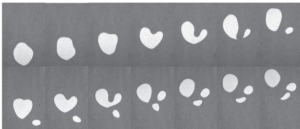
FIGURE V.5 - **Double fragmentation d'une bulle unique.** [ $h = 2.3$  mm,  $\eta_s = 450$  mPa.s,  $\phi_0 = 0.30$ ]
