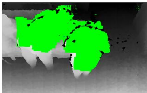
Figure 3-10 : Exemple d'erreur de sélection de région dans l'image de profondeur : La personne est occultée par les aides-soignants présents dans la pièce.
