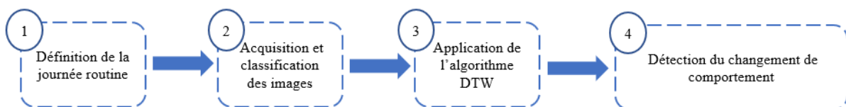
Figure 5-10 : Schéma de la détection du changement de comportement au moyen de la déformation temporelle dynamique.
