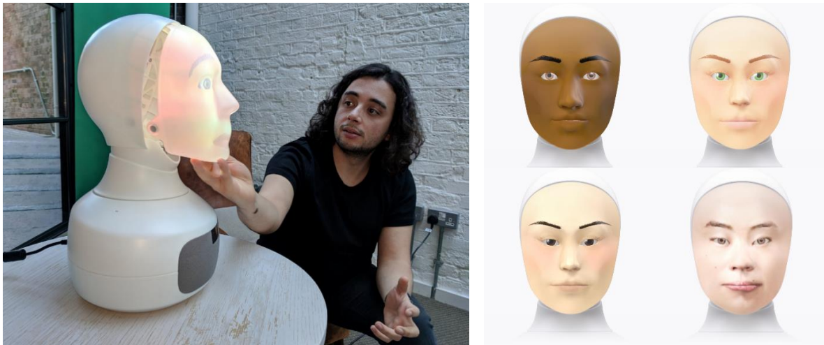
Figure 2. A gauche, le robot Furhat et Samer Al Moubayed, directeur général de Furhat Robotics, et à droite, certains des masques qui peuvent être projetés sur le robot.
