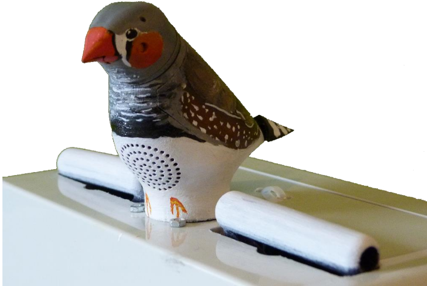
Figure 16. Le robot-diamant mandarin MANDABOT utilisé pour l'expérience d'apprentissage du chant. Il a la taille et l'apparence d'un mâle mandarin adulte.
