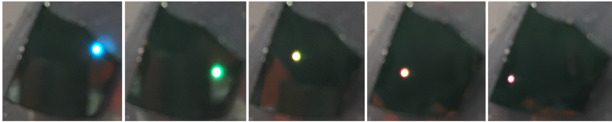
Figure V.19 : Série de photographies de l'échantillon à multi-puits quantiques crus sur des pyramides d'InGaN sur graphène sous excitation laser (325 nm).
