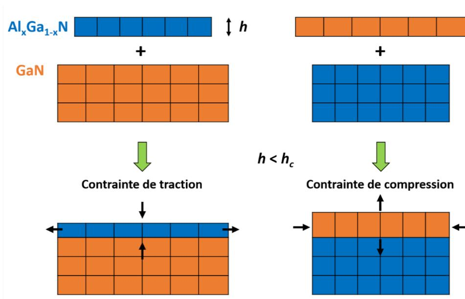
Figure I-3 : Schéma d'une hétérojonction GaN/AlGaN et AlGaN/GaN. Cas de contrainte de traction/compressive pour une couche d'AlGaN/GaN sur GaN/AlGaN d'épaisseur  $h$  en deçà de l'épaisseur critique ( $h_c$ ).
