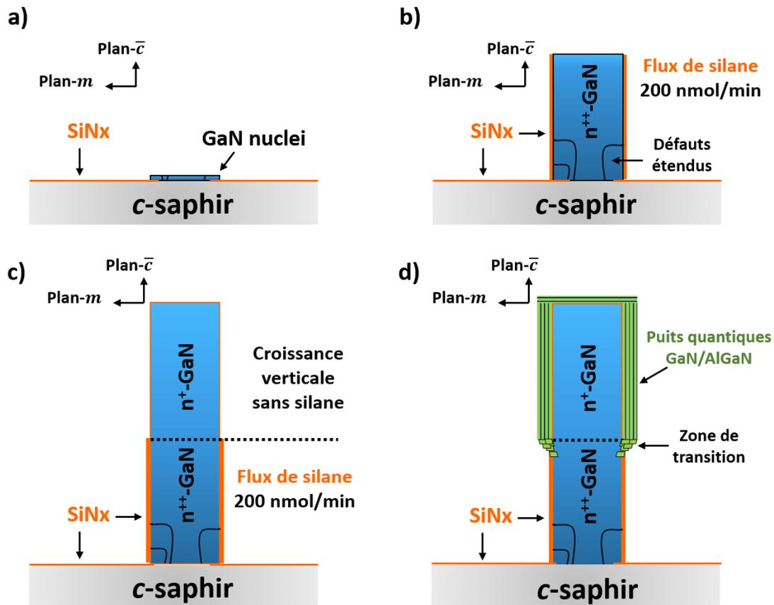
Figure II-2 : Schéma des différentes étapes de croissance : a) Passivation partielle du substrat avec du SiN<sub>x</sub> et nucléation du GaN. b) Croissance de la partie n<sup>++</sup> des fils de GaN sous flux de silane. c) Croissance de la partie n<sup>+</sup> des fils de GaN sans flux de silane. d) Croissance sélective sur la partie supérieure d'un fil d'une coquille comportant des puits quantiques, ici GaN/AlGaN.
