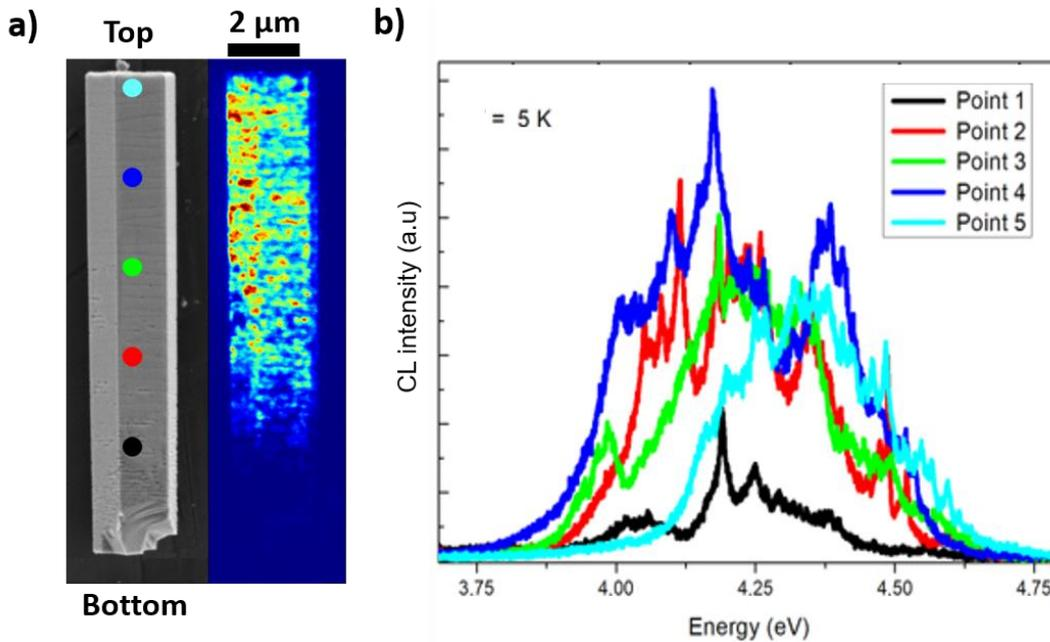
Figure III-11 : a) Image SEM et cartographie CL d'un fil unique de GaN avec des puits cœurs-coquilles de 0.7 nm GaN (0.7 nm)/Al<sub>0.6</sub>Ga<sub>0.4</sub>N (5 nm), dispersé sur un substrat de Si et mesuré à 5 K. (b) Spectres de CL mesurés localement (résolution latérale ≈100 nm) à différentes positions le long du fil, indiquées par des points colorés sur l'image SEM.[81]
