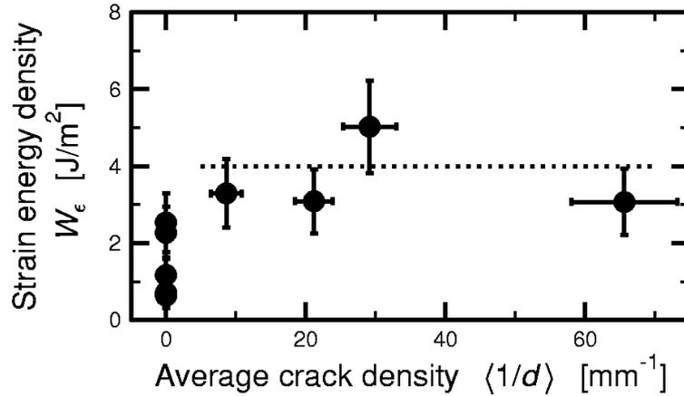
Figure IV-12 : Énergie de déformation élastique par unité de surface (calculée à partir de mesures XRD) pour une couche d' $\text{Al}_x\text{Ga}_{1-x}\text{N}$  de  $1 \mu\text{m}$  sur GaN plan-c, en fonction de la densité moyenne de fissures. La ligne pointillée pour la valeur seuil de  $4 \text{ J.m}^{-2}$  est un guide pour l'œil.[123]
