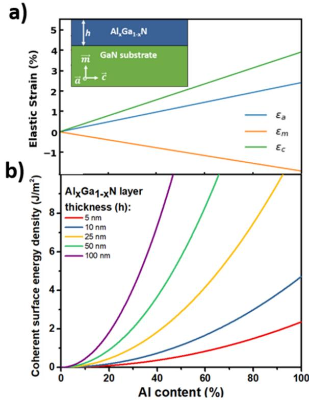
Figure IV-2 : a) Déformation élastique le long des axes  $c$ ,  $a$  et  $m$  en fonction de la teneur en Al d'une couche planeaire d' $Al_xGa_{1-x}N$  en épitaxie cohérente sur un substrat de GaN (voir encadré). b) Densité d'énergie élastique par unité de surface correspondante, calculées pour plusieurs épaisseurs  $h$  de couche d' $Al_xGa_{1-x}N$ . [114]
