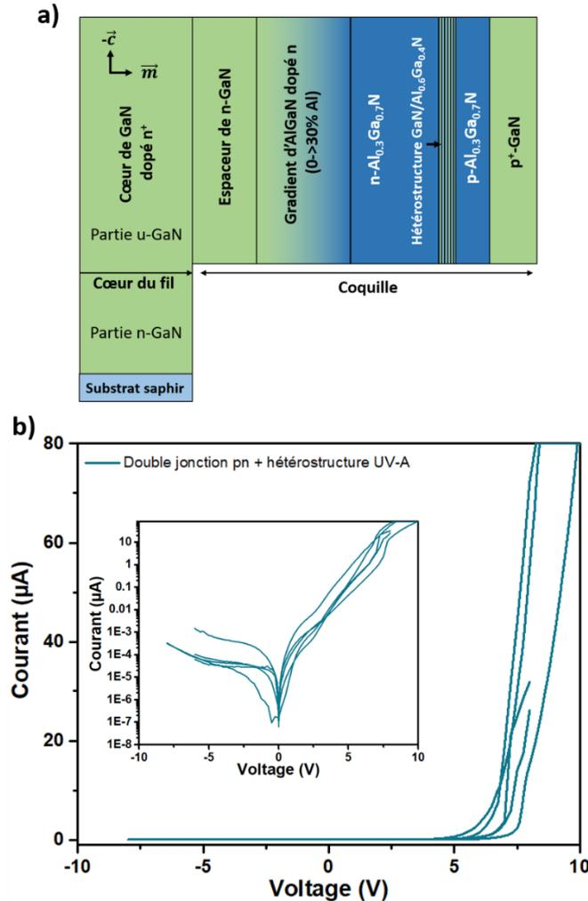
Figure V-6 : a) Schéma de la structure cœur-coquille pour l'émission dans l'UV-A avec 5 puits quantiques 5x GaN (2.6 nm)/Al<sub>0.3</sub>Ga<sub>0.7</sub>N (3nm) intégrés dans une jonction p-n GaN/Al<sub>0.3</sub>Ga<sub>0.7</sub>N (#T2763). b) Courbes I-V à température ambiante sur plusieurs fils uniques avec une hétérostructure cœur-coquille GaN/Al<sub>0.3</sub>Ga<sub>0.7</sub>N pour l'UV-A et la jonction p-n GaN/AlGaN.
