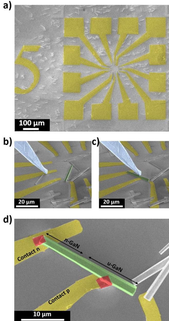
Figure V-3 : a) Image SEM d'un motif Ni/Au (jaune) sur un substrat de  $\text{SiO}_2/\text{Si}$ , sur lequel les fils cœurs-coquilles sont dispersés mécaniquement. b,c) Images SEM du déplacement d'un microfil (vert) sur des contacts Ni/Au (jaune) à l'aide d'un micromanipulateur (bleu). d) Image SEM du dépôt de tungstène (rouge) par EBID pour faire les contacts n et p d'un microfil de GaN (vert) avec une structure cœur-coquille.
