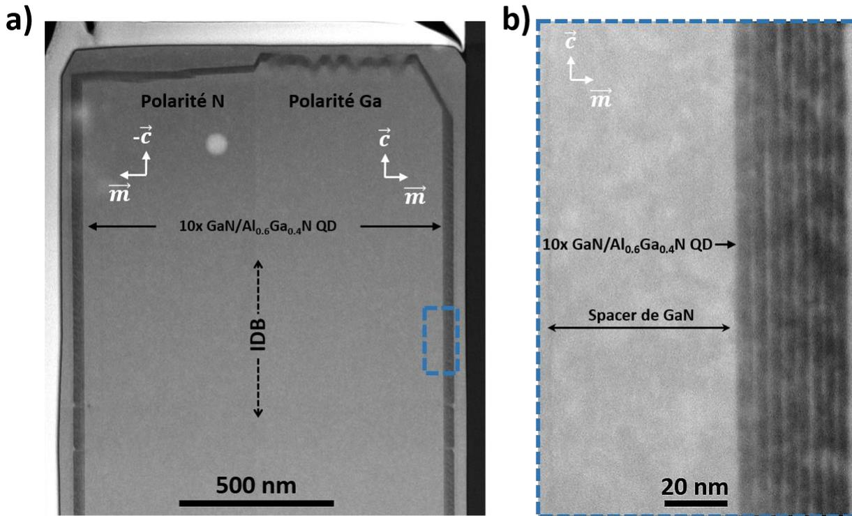
Figure III-12 : Image STEM-HAADF le long de l'axe de zone  $[11\bar{2}0]$  d'une section longitudinale préparée au FIB sur la partie supérieure d'un fil cœur-coquille GaN/AlGaN avec 10 puits de GaN de 0.7 nm (#T2579). Images de faible grossissement sur le sommet du fil (a) et zoom sur l'hétérostructure non polaire sur une facette du fil (b).
