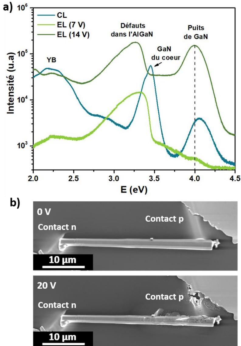
Figure V-10 : a) Spectres EL (vert) à 7 et 14 V et CL (bleu) d'un fil cœur-coquille, avec une hétérostructure 5x GaN (0.4 nm)/Al<sub>0.6</sub>Ga<sub>0.4</sub>N (3nm) au milieu de la jonction p-n GaN et Al<sub>0.3</sub>Ga<sub>0.7</sub>N (#T2778). b) Images SEM d'un fil contacté par EBID avant et après lui avoir appliqué une tension de crête de 20 V.
