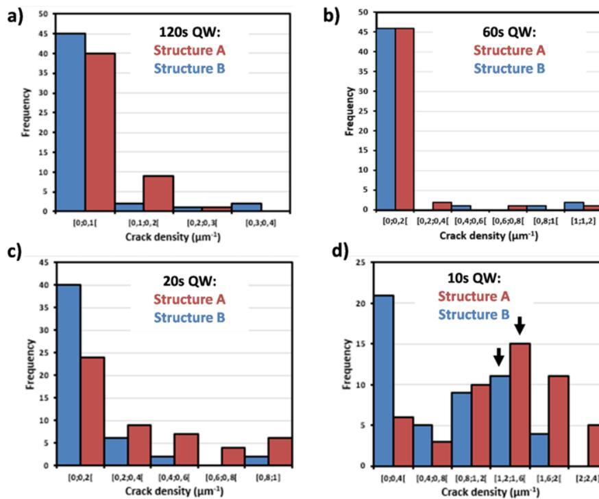
Figure IV-11 : Histogrammes de la distribution de la densité de fissure fait sur des ensembles de 50 fils, pour les structures cœurs-coquilles de type A et B. La distribution statistique est montrée pour les différents temps de croissance des puits : a) 120 s (#T2698, #T2640), b) 60 s (#T2700, #T2742), c) 20 s (#T2701, #T2731) et d) 10 s (#T2703, #T2741).[114]
