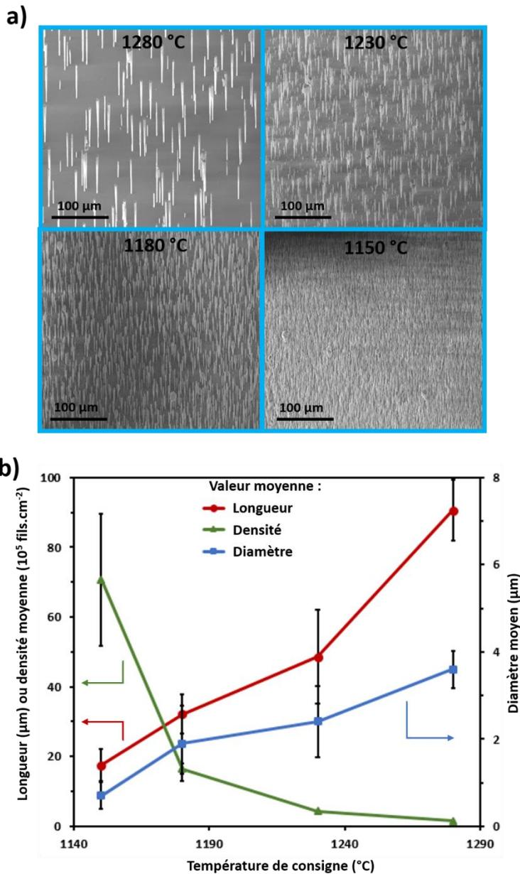
Figure II-4 : a) Images SEM de fils de GaN inclinés à 30° de même grossissement, croissance sur un substrat de saphir (orientation c) pendant 700 et 400 s pour les parties n- et u-GaN (#T2552). Pour les quatre échantillons, seule la température de croissance et nucléation des fils est changée (1280, 1230, 1180, 1150 °C). b) Courbe d'étalonnage des densités, longueurs et diamètres moyens en fonction de la température de croissance et nucléation des fils.
