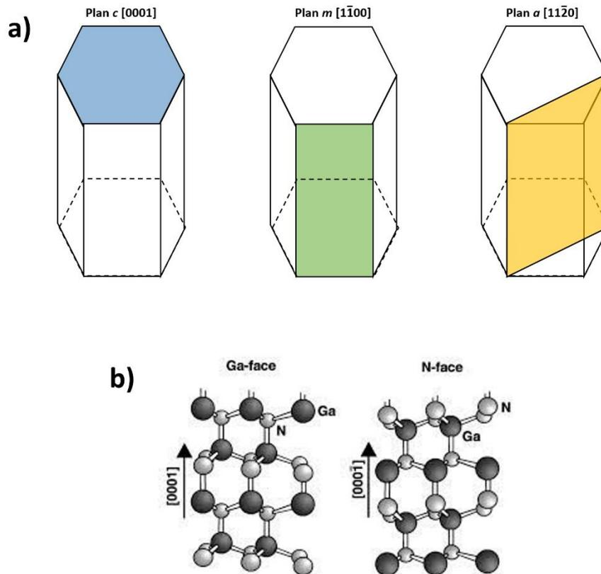
Figure I-2 : a) Plans cristallins  $c$ ,  $m$  et  $a$  dans la structure hexagonale wurzite. b) Les deux types de polarité du GaN : Ga-polaire le long de  $[0001]$  et N-polaire le long de  $[000\bar{1}]$ .
