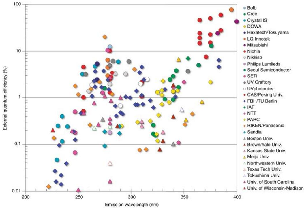
Figure I-8 : Rendement quantique externe (EQE) des LED UV à base d'AlGaIn ( $\lambda < 365 \text{ nm}$ ) en fonction de la longueur d'onde d'émission, obtenu par différents groupes de recherche.[13]
