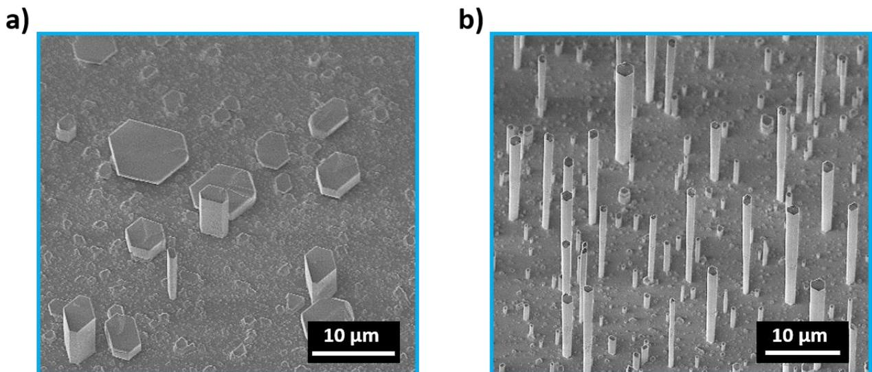
Figure II-3 : Image SEM inclinée à 30° d'une croissance de fils de GaN sur substrat de saphir avec : (a) un flux de silane de  $100 \text{ nmol.min}^{-1}$ , insuffisant pour favoriser la croissance verticale et (b) un flux de silane de  $200 \text{ nmol.min}^{-1}$ , suffisant pour la formation de microfils.
