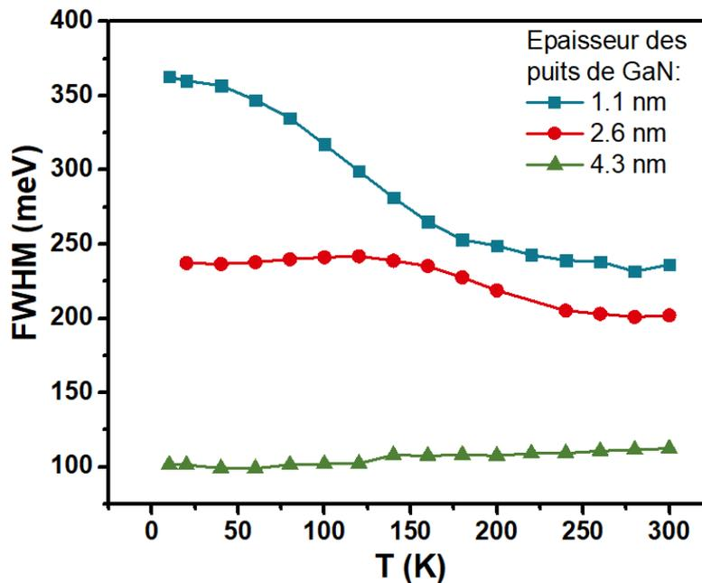
Figure III-9 : Evolution de la largeur à mi-hauteur (FWHM) du pic d'émission des puits de GaN en fonction de la température pour des hétérostructures cœurs-coquilles GaN/Al<sub>0.6</sub>Ga<sub>0.4</sub>N (5.5 nm) avec des puits de 1.1, 2.6 et 4.3 nm (#T2563, #T2551 et #T2578). Les données sont extraites des spectres PL présentés en Figure III-7(a, b, et c).
