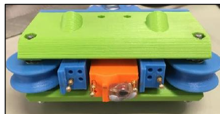
Figure 94 : Sonde à courant de Foucault et à chute de potentiel (Bacelar, 2017)
