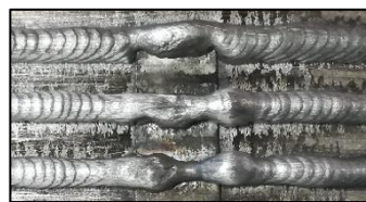
Figure 108: Non mouillage de cordons de soudure en alliage d'aluminium sur un témoin en acier
