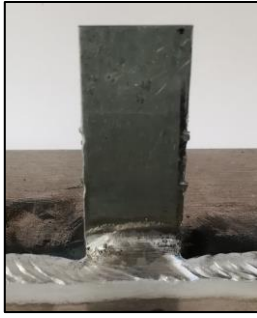
Figure 110: Vue de face d'un cordon soudé à un témoin en acier galvanisé
