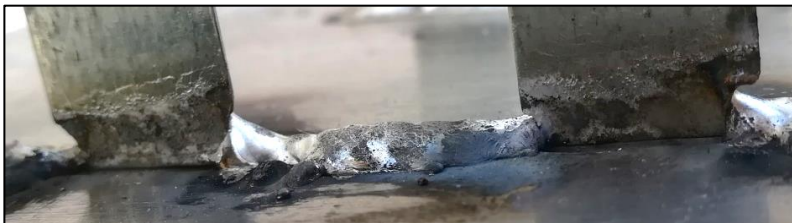
Figure 117 : Détérioration au dos des témoins pour un offset trop faible
