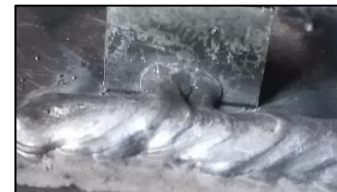
Figure 118 : témoin non lié avec un cordon pour un offset trop grand
