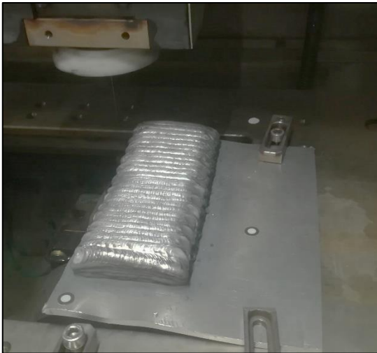
Figure 69 : Première étape de contournage sur le Bloc T
