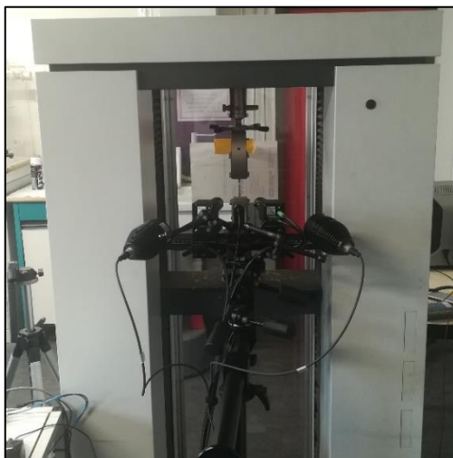
Figure 73: Machine de traction MTS4M et système ARAMIS de suivi de déformation
