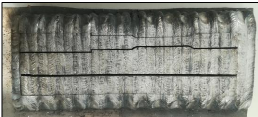
Figure 71: Bloc T Contourné en 2 sous blocs
