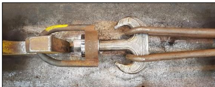
Figure 100 : Crochet de levage réalisé en WAAM (Jackson, 2018)
