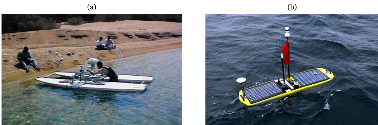
Figure 2. 21. Deux systèmes de cartographie du niveau marin basés sur le GNSS. (a) Déploiement du catamaran GPS au large de la Corse (Bonnetfond et al. 2003). (b) Déploiement du GNSS wave-glider en Mer du Nord (Sources : M. Maqueda blog ).
