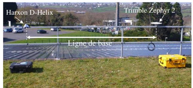
Figure 6. 6. Dispositif expérimental.
