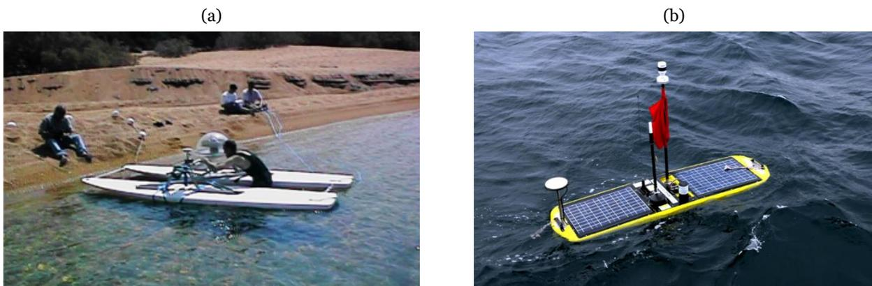
Figure 2. 21. Deux systèmes de cartographie du niveau marin basés sur le GNSS.
