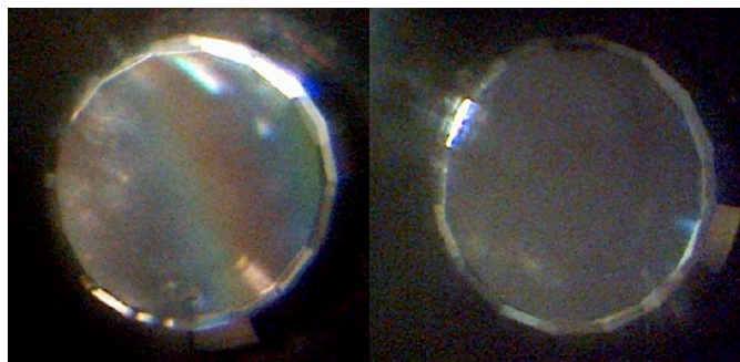
FIGURE III.17 – Vue en transmission des deux diamants posés l'un contre l'autre. À gauche l'alignement est mauvais on voit distinctement 2 franges d'interférences. À droite l'alignement est correct. GRASSET (2017).
