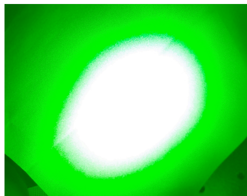
FIGURE III.3 – Image d'un filtre spatial correctement aligné. La tâche est parfaitement circulaire.
