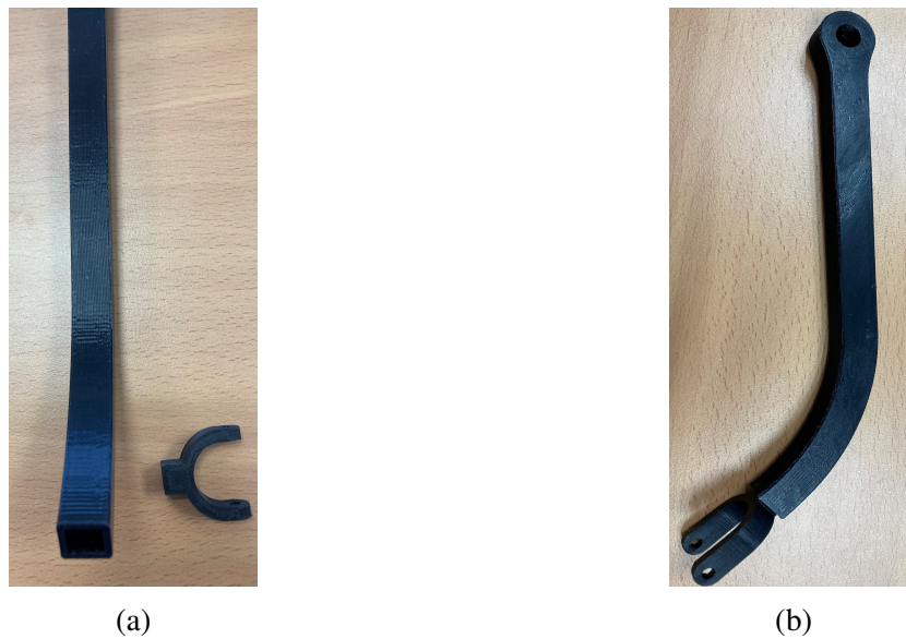
FIGURE 4.8 – Représentation du résultat d'impression du bras supérieur et la fourche du joint universel : (a) démontage et (b) assemblage via la liaison d'encastrement par collage.
