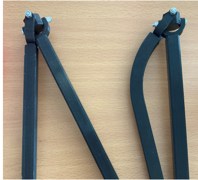
FIGURE 4.6 – Utilisation de bras inférieurs courbés au lieu de bras droits
