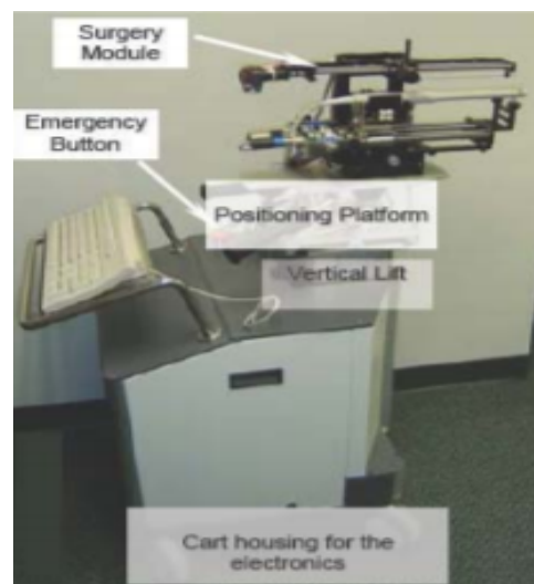
FIGURE 1.8 – Robot sériel composé d'un module de positionnement et d'un module de chirurgie qui a été proposé par [61]
