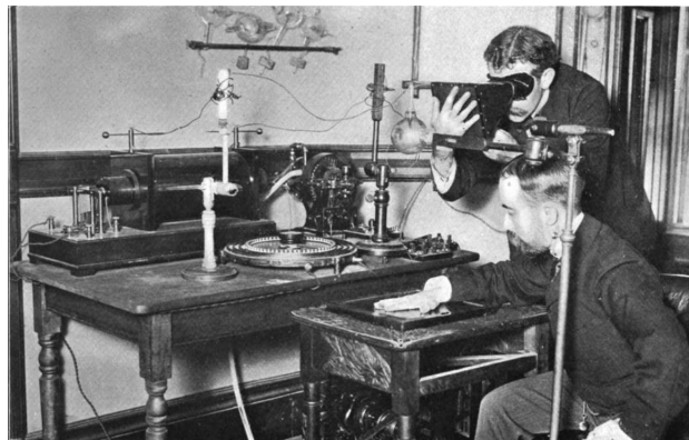
FIGURE 5 – Étalonnage d'un tube à rayons X de Crookes "à la main", Philadelphie, État de Pennsylvanie, 1896. [56]
