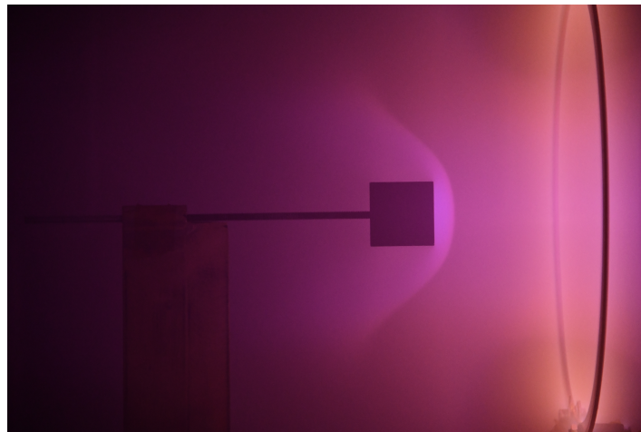
FIGURE 4.36 – Photographie de l'onde de choc autour d'un cube de 30 mm à Mach 4 - 2,7 Pa visualisée grâce à la méthode de la luminescence.
