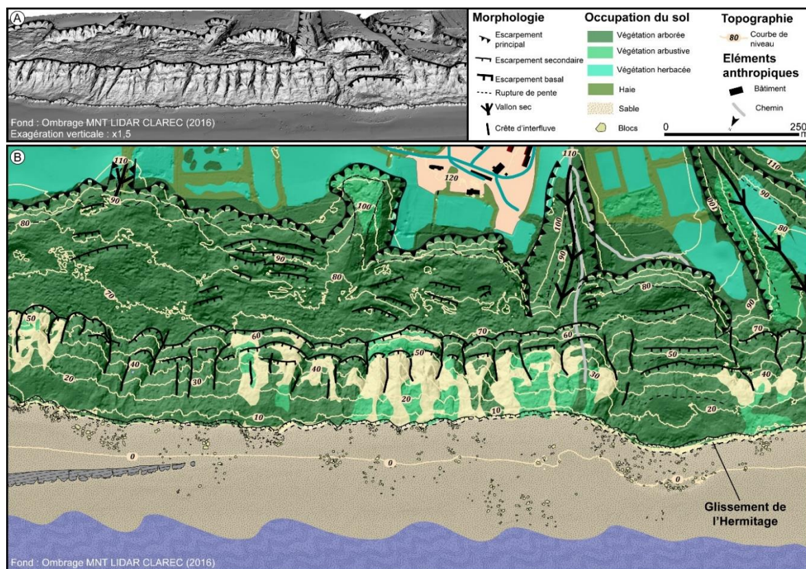
Figure 4.6 : Exemple de carte morphologique réalisée dans le secteur d'Auberville et du glissement de l'Hermitage ; A) Représentation en vue 3D du modèle ombragé LIDAR CLAREC (2016) avec exagération verticale \times 1,5 ; B) Carte morphologique réalisée à partir du fond ombragé du LIDAR CLAREC (2016)
