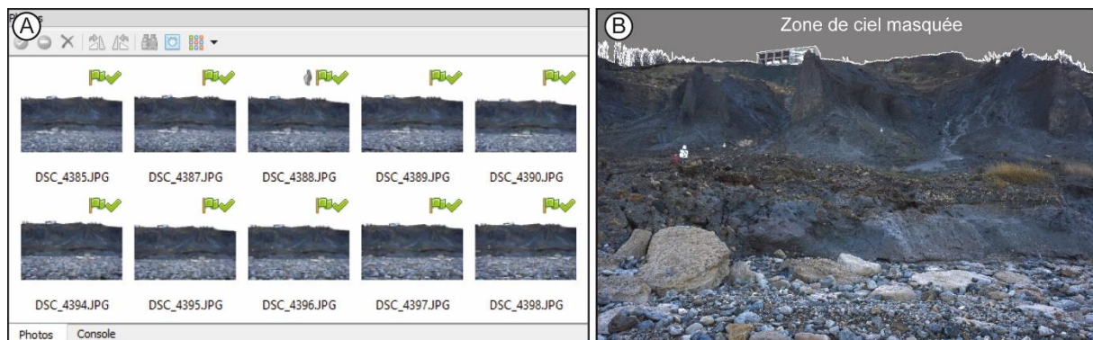
Figure 6.3 : Première étape de la création des modèles photogrammétriques SfM ; A) Intégration des photographies dans le logiciel ; B) Masquage automatique des zones à retirer des modèles à l'aide de l'outil "baguette magique"
