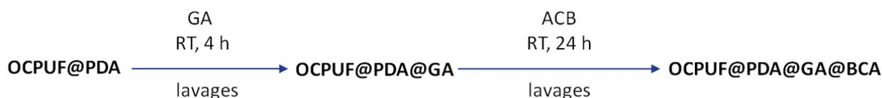
Figure 57 : Schéma réactionnel d'immobilisation covalente des anhydrases carboniques bovines sur OCPUF@PDA par greffage de glutaraldéhyde.
