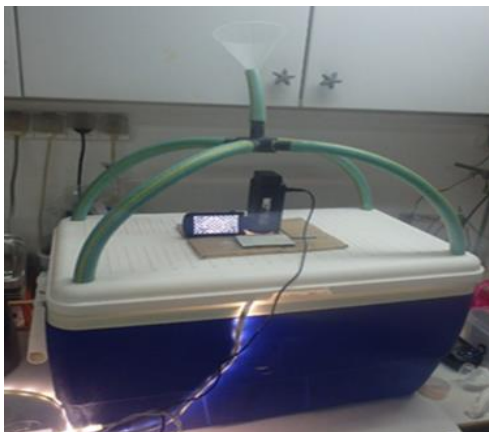
Figure 95 : schéma illustrant le dispositif de camouflage dynamique et photo du dispositif à l'extérieur et à l'intérieur. L'animal est placé dans un cylindre en verre au centre d'un dispositif fermé gris uniforme ou avec un motif d'échiquier contenant de l'eau de mer claire. On ajoute de la turbidité à t=15\text{min} via l'entonnoir qui délivrera l'eau turbide aux coins du dispositif facilitant le mélange entre l'eau claire et l'eau turbide. Le camouflage de l'animal sera déterminé avant, pendant et après l'ajout d'eau turbide à l'aide d'une caméra vidéo.
