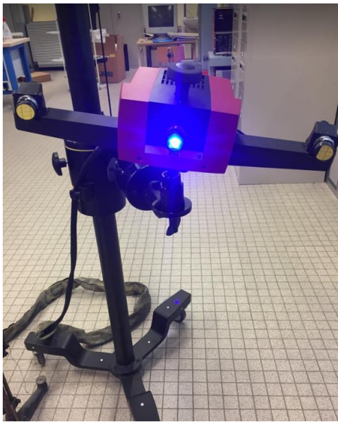
Figure 2. 10 Le scanner 3D ATOS composé d'une caméra stéréo et de 2 capteurs
