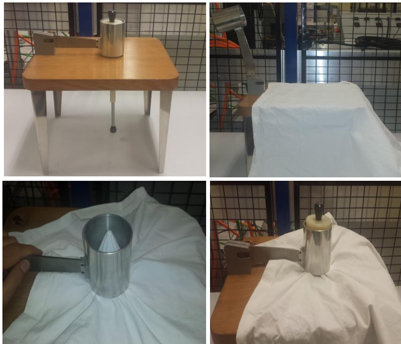
Figure 2. 6 Génération du froissement par la méthode de cylindre creux.
