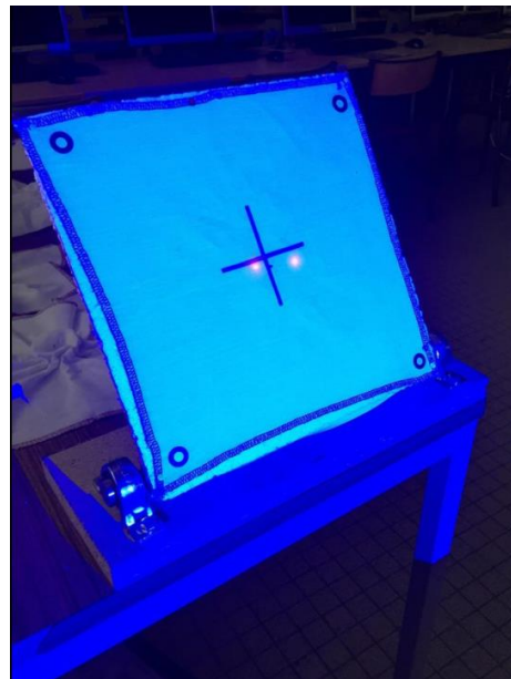
Figure 2. 11 Echantillon fixé sur un support avec une inclinaison de 80°.
