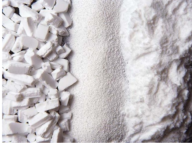
Figure 38: Forme de silice après compactage, broyage et micronisation (Solvay GBU Silica). Les granules ont une taille de 1 à 3mm, les microperles d'environ 200 \mu m et les poudres de 15 à 30 \mu m.
