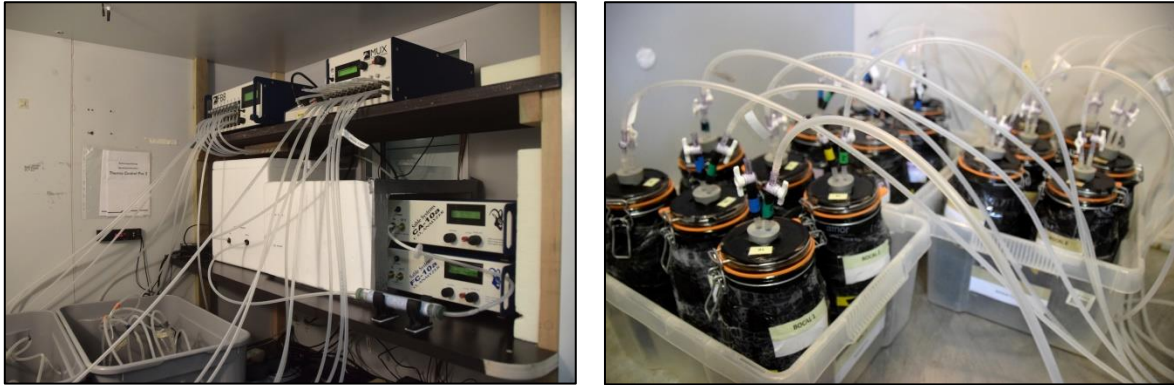
Figure 25 : Appareil de contrôle des débits et analyseurs et chambres de tests opaques utilisées pour la respirométrie
