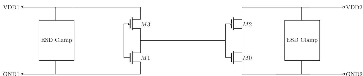
Figure 1.24 : Schéma de principe d'une connexion entre deux domaines de puissance
