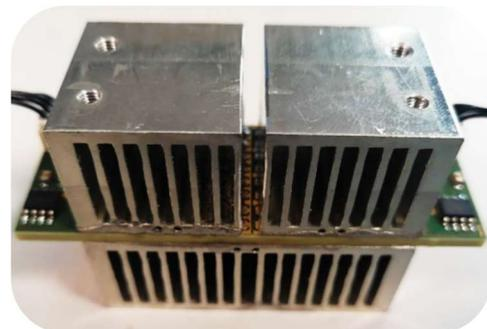
**Figure III. 19 : Cellule de commutation sans condensateur intégré**
