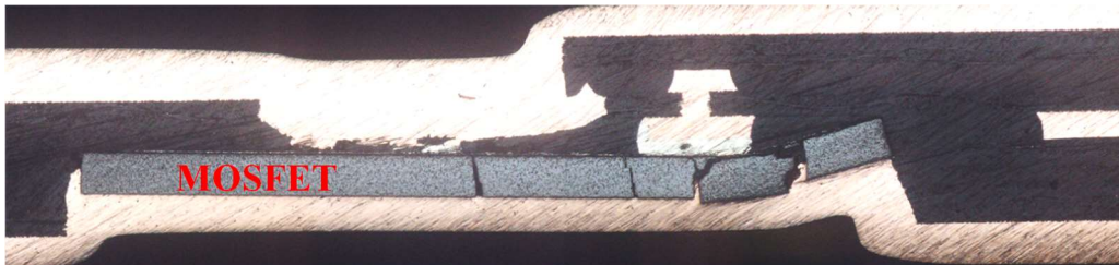
Figure II. 36 : MOSFET brisé à l'intérieur du PCB après assemblage sur les dissipateurs
