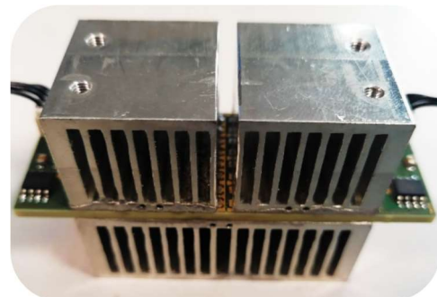
Figure III. 19 : Cellule de commutation sans condensateur intégré
