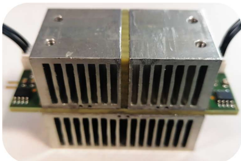
Figure III. 18 : Cellule de commutation avec condensateur de découplage intégré
