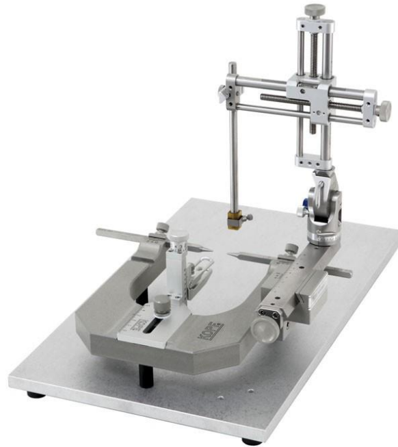
Figure 2.2.1 : Cadre stéréotaxique Kopf utilisé pour l'implantation tumorale ainsi que pour l'injection en CED des nanoparticules.
