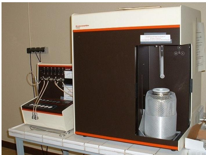
*Figure 11 : appareil Tristar 3000 pour l'obtention des isothermes d'adsorption.*
