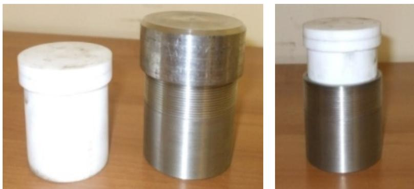
*Figure II. 1: Réacteur utilisé pour la synthèse des catalyseurs.*
