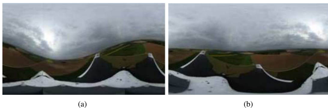
FIGURE 3.6 – Dans [Caron & Morbidi 2018], (a) l’orientation d’un drone à voilure fixe est estimée à partir des images acquises par une caméra Ricoh Theta S, dans le but de (b) corriger l’image obtenue.
