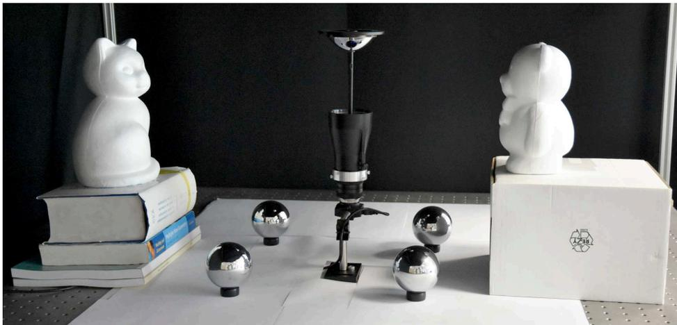
**FIGURE 2.13** – Expérimentations avec images réelles : le capteur catadioptrique, les objets *Chat* et *Ourson*, ainsi que les quatre sphères réfléchissantes pour l’estimation des directions d’éclairage.
