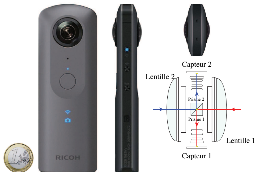
FIGURE 3.10 – Vues de face, de côté et du dessus de la caméra twin-fisheye Ricoh Theta V, accompagnées du schéma du système optique interne du boîtier comportant deux lentilles fisheye, deux prismes et deux matrices photosensibles CMOS.
