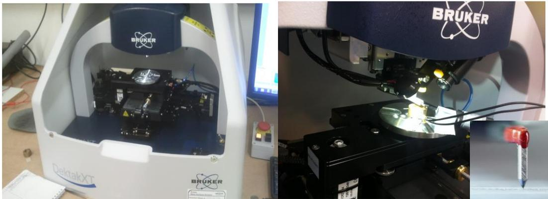
Figure 3-1 : a) Le profilomètre Bruker DektakXT b) Le profilomètre en fonctionnement sur un plot
