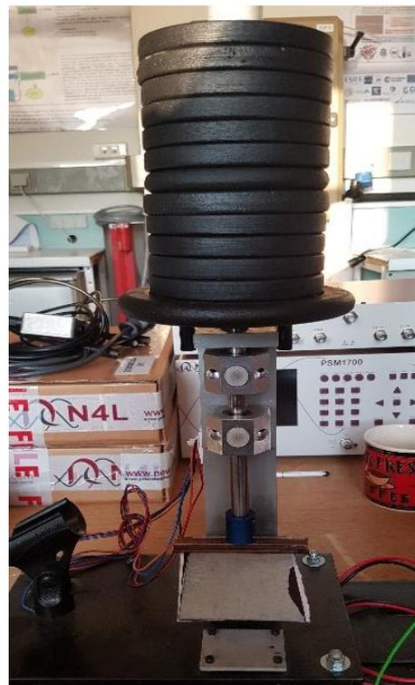
Figure 3-22 : Montage expérimental de visualisation des contacts. En haut : superposition des différentes épaisseurs de feuilles. En bas : pression du système sur la caténaire. À droite : accumulation des poids pour le contact.
