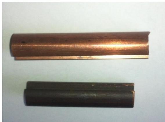
Figure 3-3 : Échantillon de fil de contact neuf (en haut) et de fil de contact usé (en bas)
