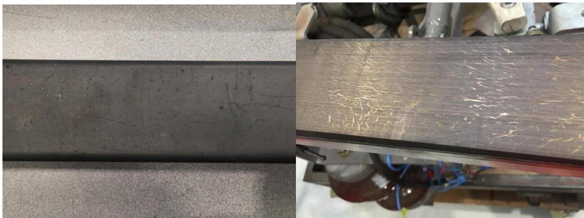
Figure 5-19 : Bande de captage en carbone pur à gauche et imprégné de cuivre à droite
