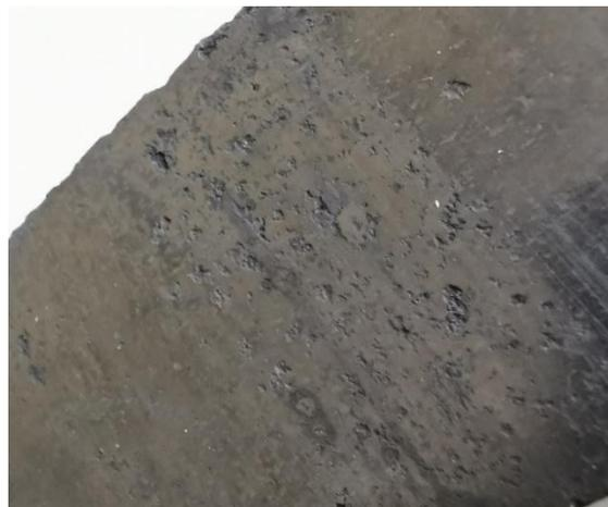
Figure 1-20 : Photographie d'une usure par arc électrique
